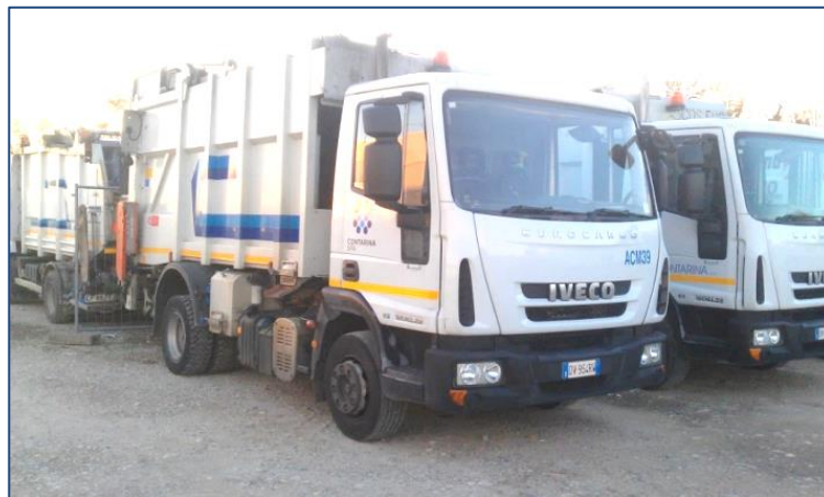
Fig. 8: Automezzo con mini compattatore posteriore, ACM
