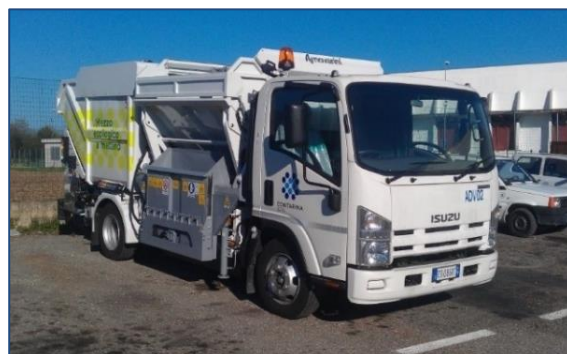
Fig. 6b: Particolare carico laterale ADV
