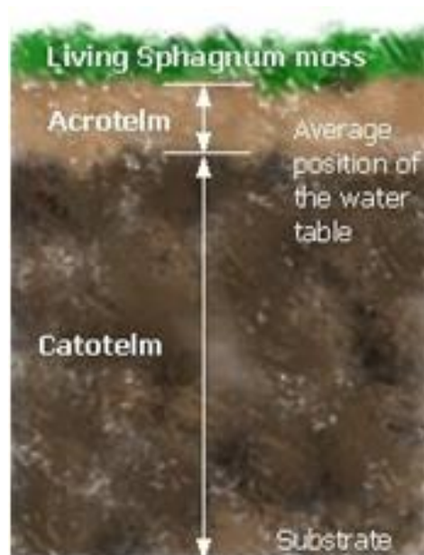
Figura 2.3 – Rappresentazione schematica della struttura tipica di una torbiera ombrotrofica [5].
