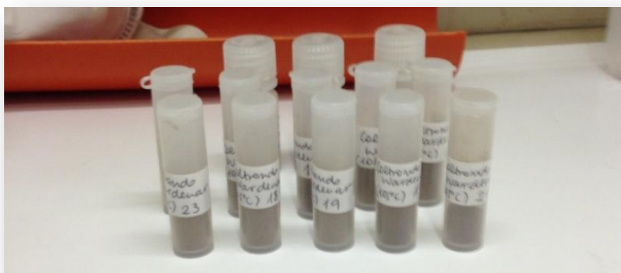
Figura 5.10 – Alcuni campioni ottenuti dopo essiccamento e macinazione, pronti per la successiva fase di disgregazione.
