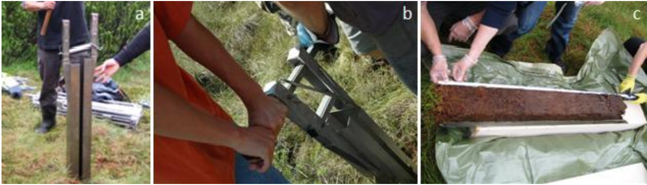
Figura 5.3 – Carotaggio effettuato con il carotiere Wardenaar. Inserimento delle lame nel materiale torboso (a-b). Monolite campionato (c).
