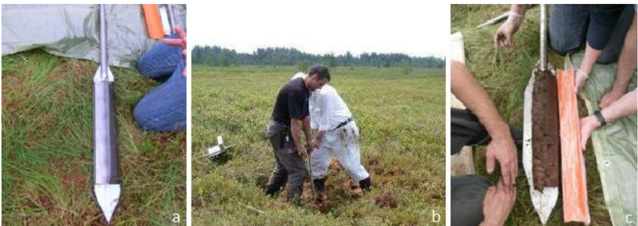
Figura 5.4 – Carotaggio effettuato con il carotiere Belarus (a). Inserimento nel materiale torboso (b). Carota prelevata (c).
