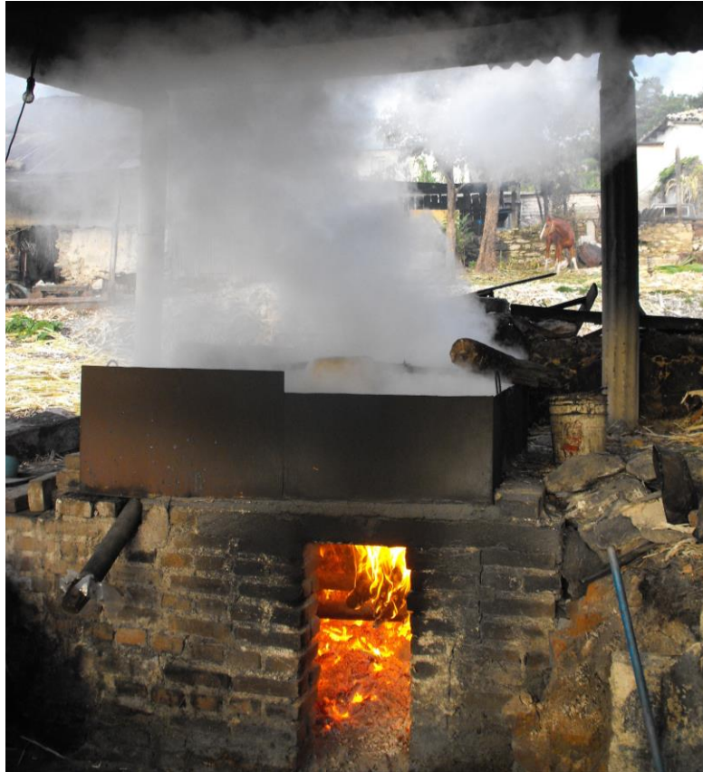
Fig. 13: Forno con contenitore fisso in azione, fotografia scattata nel novembre 2014 a Tzimol, durante la produzione di panela
