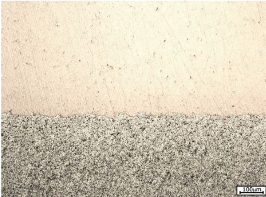
- Figura 45. Micrografia LOM a 100x - Interfaccia substrato/coating Waspaloy
