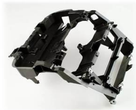
Figura 25: pezzo plastico ad iniezione non estetico. Fonte: Flextronics
