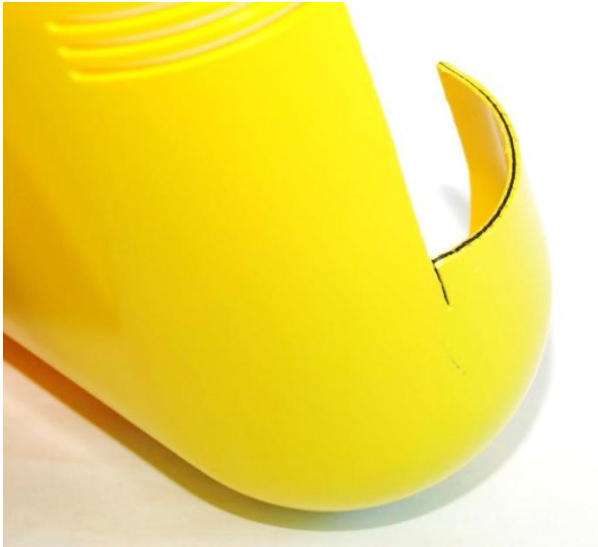
Figura 34: pezzo industriale sviluppato con co-iniezione. Fonte: Flextronics
