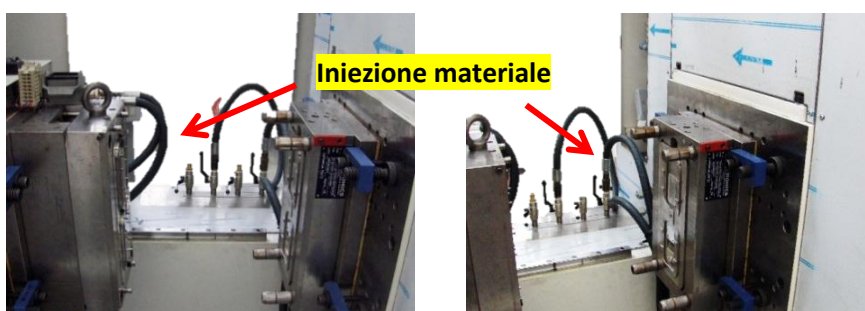
Figura 19: installazione dello stampo nella pressa ad iniezione. Fonte: Flextronics
