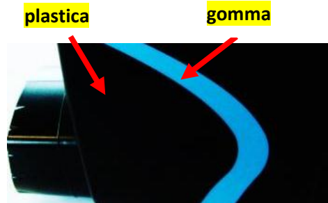
Figura 33: pezzo plastico bi-componente. Fonte: Flextronics
