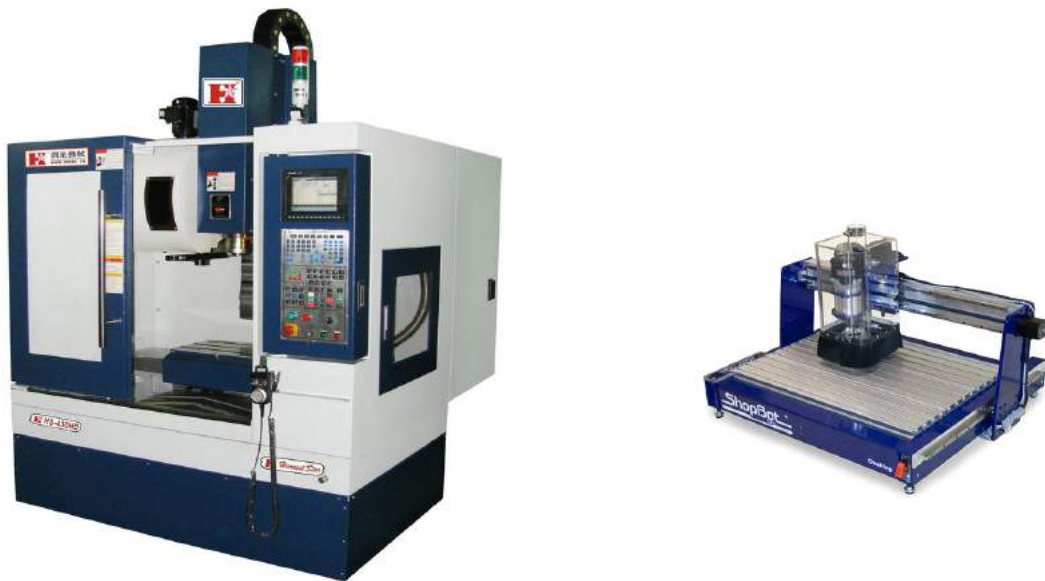
Figura 1.5. Esempio di macchine a controllo numerico. A sinistra un dispositivo industriale, a destra un dispositivo desktop
