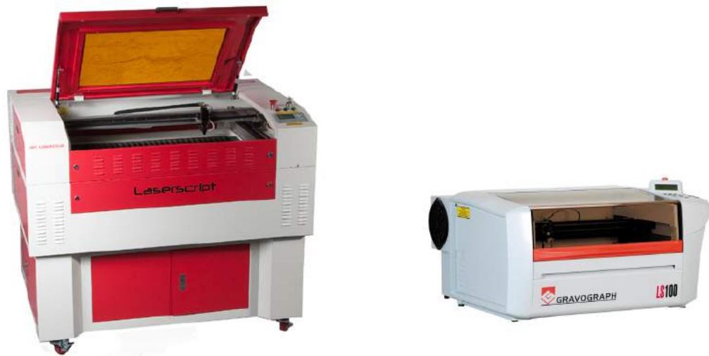
Figura 1.7. Esempi di Laser Cutter Machine. A sinistra un modello professionale, a destra un modello desktop
