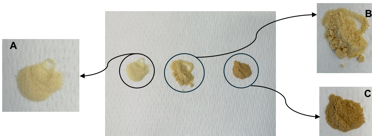
Figura 3.1 Foto del catalizzatore eterogeneo DBU@PS prima dell'utilizzo (A), dopo il primo utilizzo (B) e dopo l'ultimo riciclo (C).
