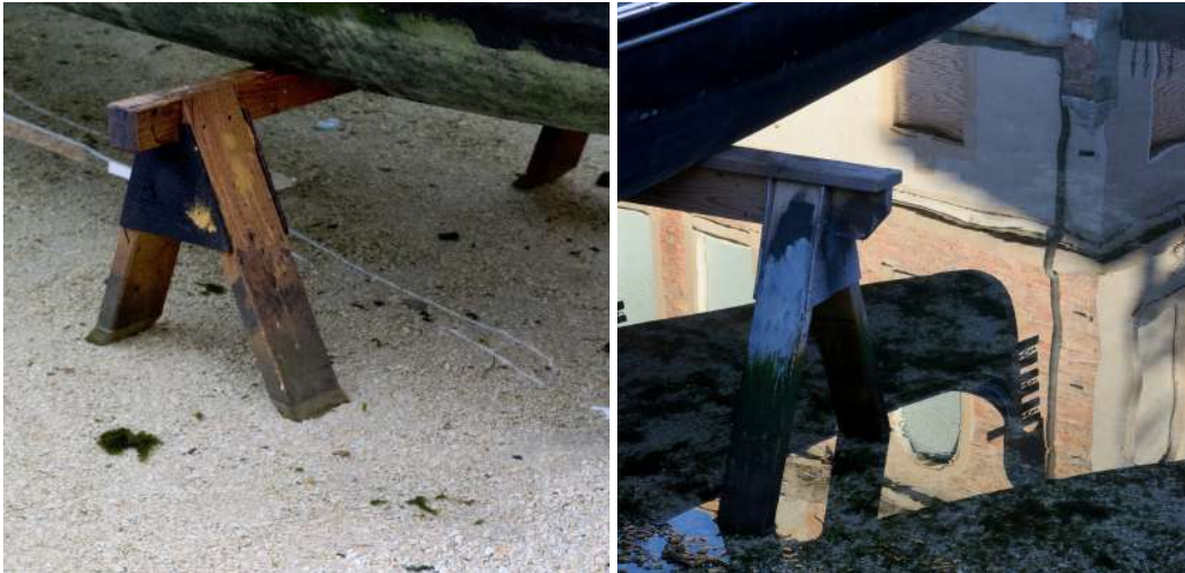
Fig.10-11. I cavalletti di legno utili a rialzare le imbarcazioni disposte sulla riva 127 128
