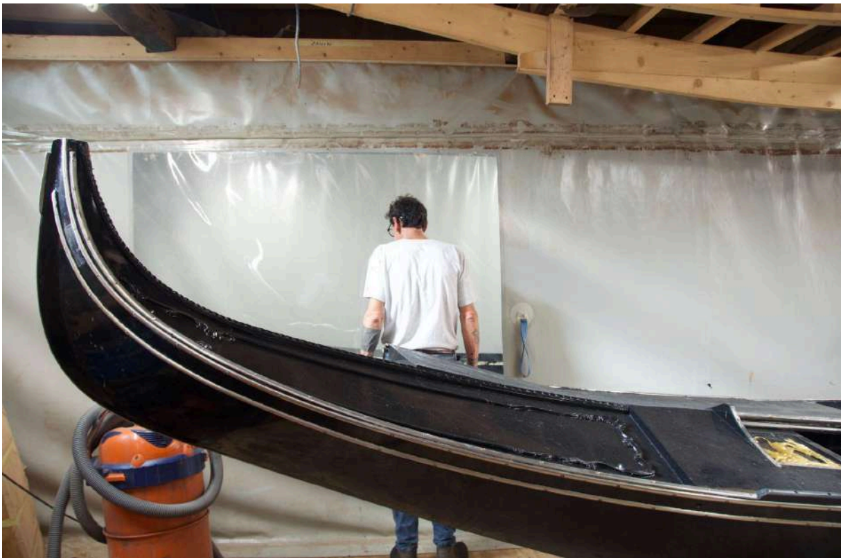
Fig.19 Marco mentre controlla la verniciatura appena passata di una gondola dall'esterno del telone bianco. 140
