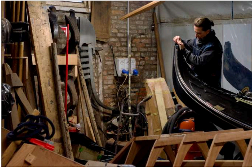
Fig. 20 Silvia all'opera sul pinzo da poppa di una gondola 147
