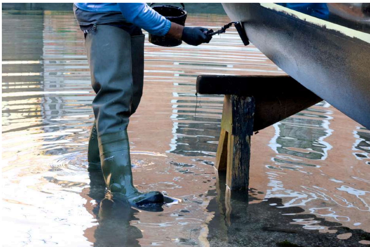
Fig.14 Gregorio mentre applica uno strato di antivegetativo su una gondola 133
