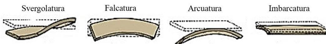
Fig. 3: Tipologie di cambiamento di forma riguardanti le tavole di legno.
