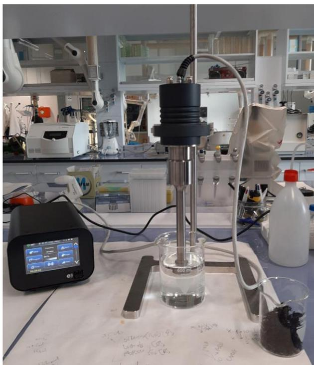
Figura 5 Sonotrodo Getwave 20 kHz generatore Titako mini 400 W utilizzato nella sperimentazione
