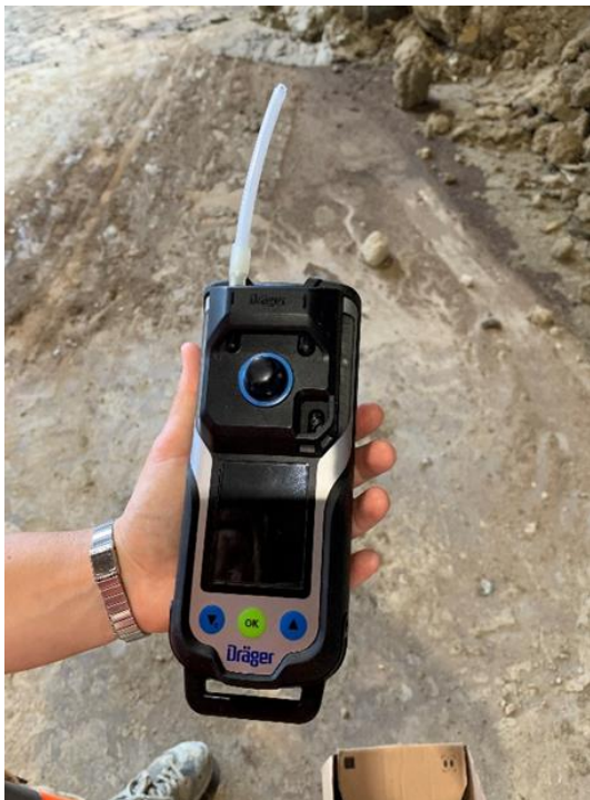
Figura 11. Misuratore di O 2 utilizzato per calcolare i valori di O 2 e CO 2 nella biopila.
