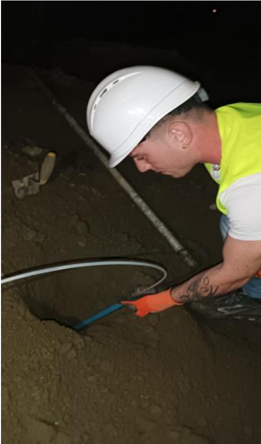
Figura 12. Inserimento della canula all'interno del cumulo per successive misurazioni.
