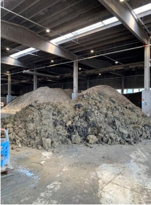
Figura 6. Dettaglio di un cumulo di terreno in attesa di essere inserito nella biopila.
