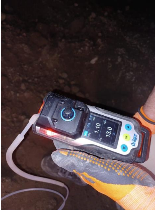
Figura 16. Dettaglio del funzionamento e dei valori riportati dal misuratore di O 2 durante un'analisi.
