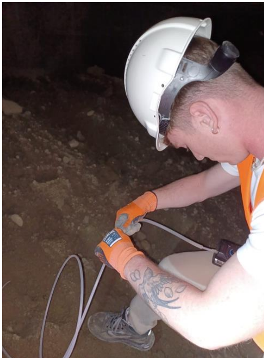
Figura 15. Fase di collegamento tra il misuratore di O 2 e la canula inserita nel cumulo.
