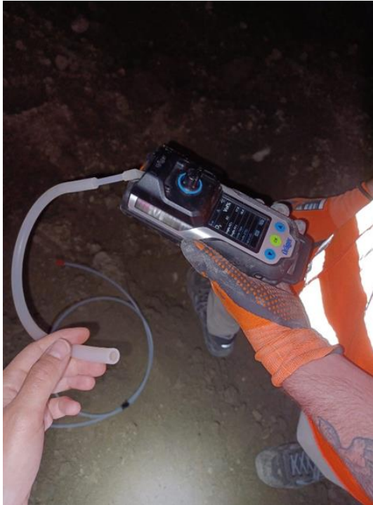
Figura 14. Dettaglio sul tubo di collegamento tra il misuratore di O 2 e la canula.
