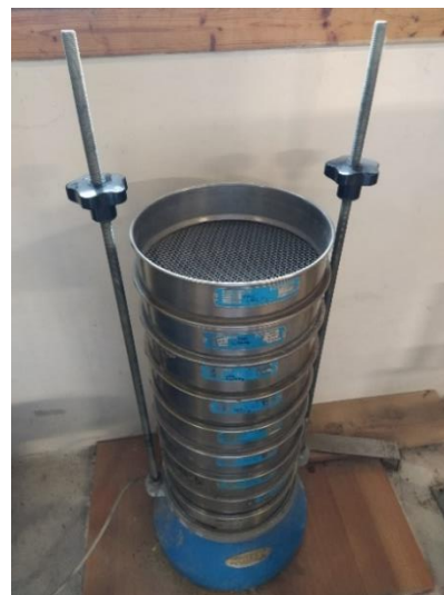
Figure 11 (sx) e 12 (dx): vagli utilizzati per la separazione delle varie frazioni granulometriche dei campioni (a sx); colonna di vagli posti su macchinario vibrante (a dx)
