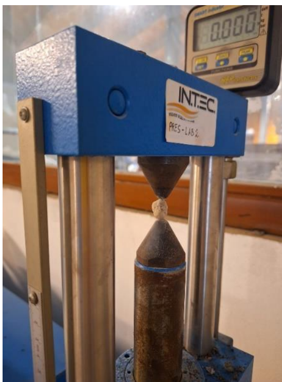
Figura 34: pressa idraulica manuale utilizzata per la valutazione della resistenza alla compressione dei granuli
