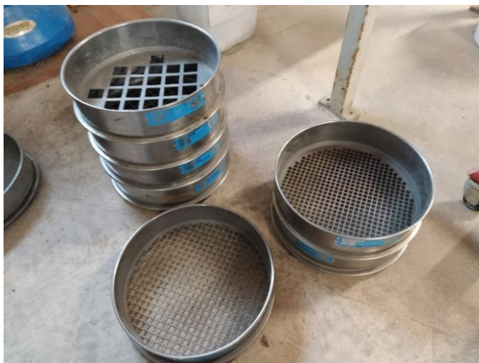
Figure 11 (sx) e 12 (dx): vagli utilizzati per la separazione delle varie frazioni granulometriche dei campioni (a sx); colonna di vagli posti su macchinario vibrante (a dx)
