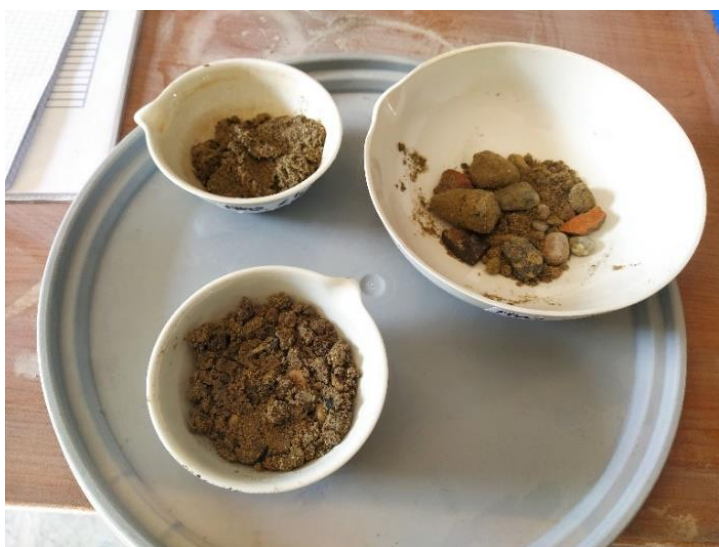
Figura 18: le tre frazioni granulometriche considerate per il lavaggio; > 10 mm, 10 mm > x > 4 mm, < 4 mm
