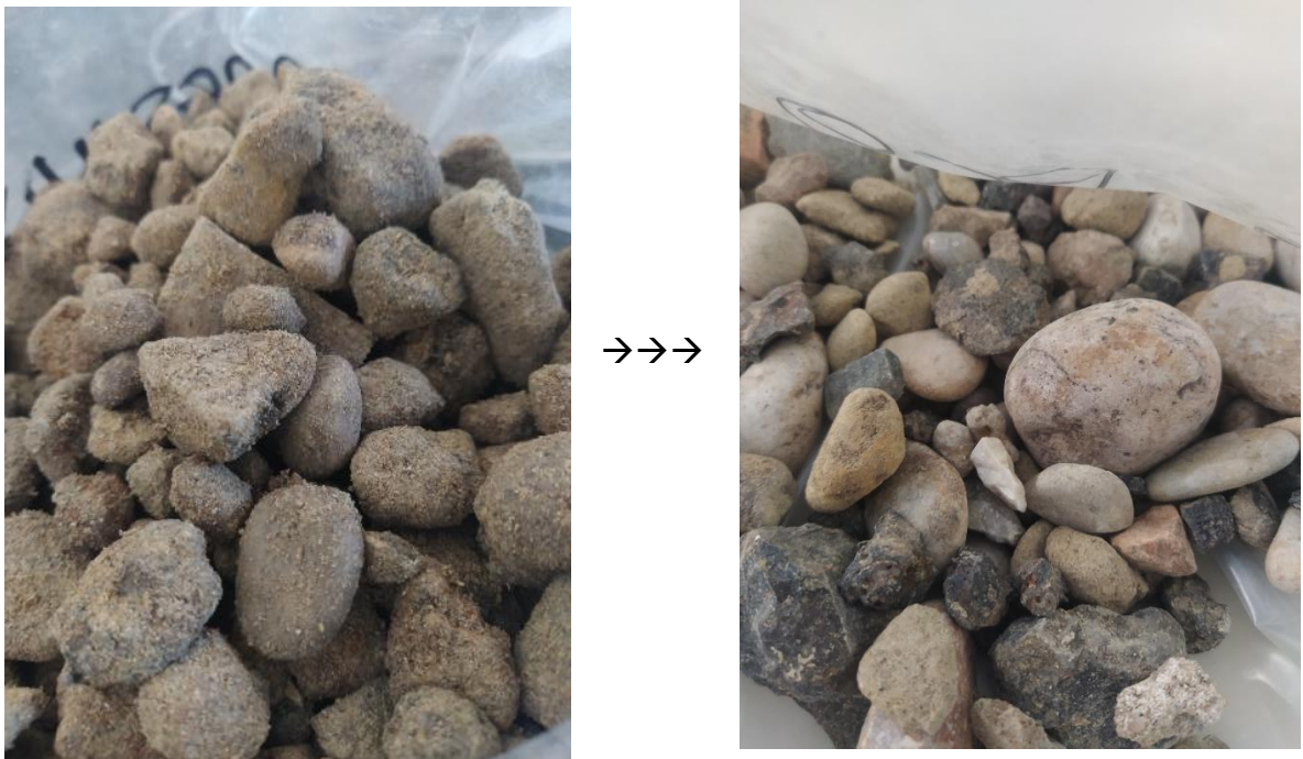
Figura 24: dettaglio dove è possibile notare l'adesione di particelle fini ai grani di maggiori dimensioni, prima del soil washing (a sx); dettaglio successivamente al soil washing, è possibile notare l'assenza di particelle fini adese, perché lavate via
