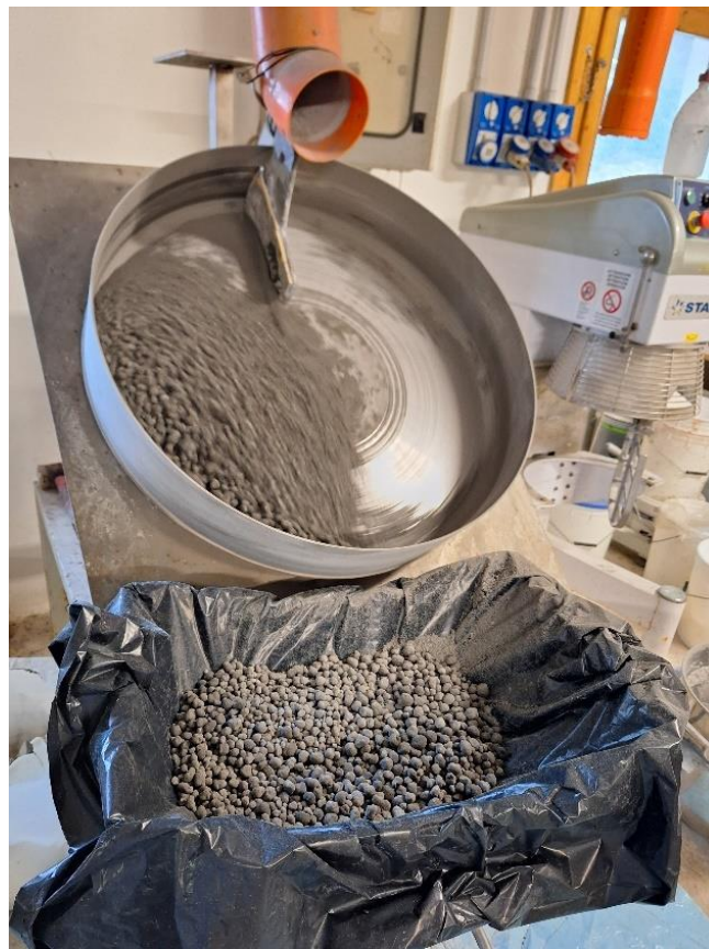
Figura 31: granulazione su piatto granulatore
