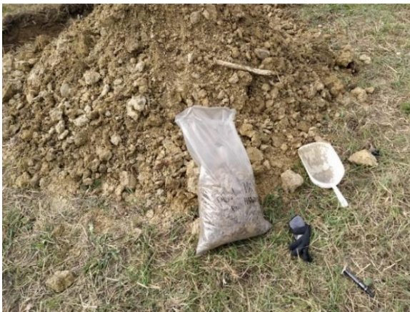
Figura 8: foto scattata nel luogo del campionamento, con gli attrezzi utilizzati (sacchi in nylon, sessola e guanti)
