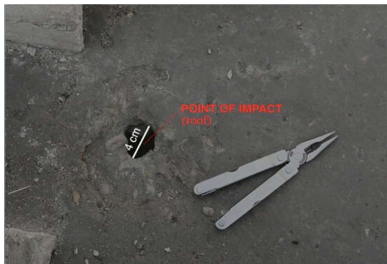
Fig.20: Rilevazione delle dimensioni di un buco lasciato sul tetto di un edificio compiuta da Chris Cobb Smith a Gaza, 2009.
