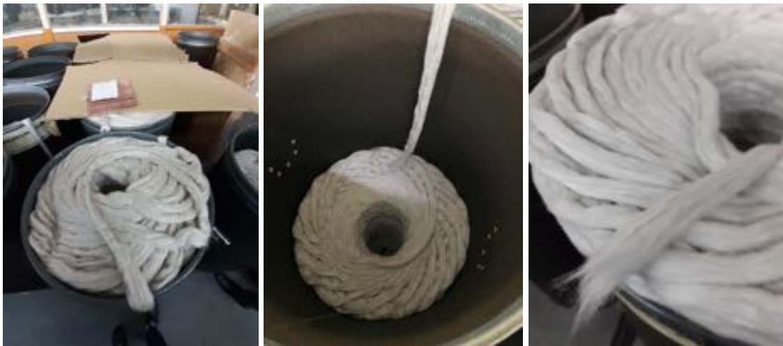
Figura 57 – Fase 6: Accoppiatura di 5/6 nastri carda sullo stiratoio.
