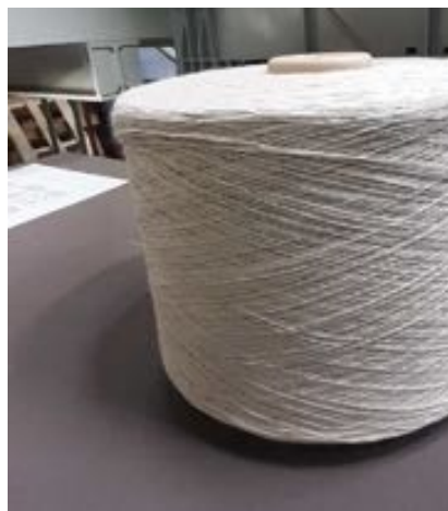
Figura 59 – Fase 8: Vaporizzo in autoclave per dare una mano molto più morbida e meno nervosa al filato.
