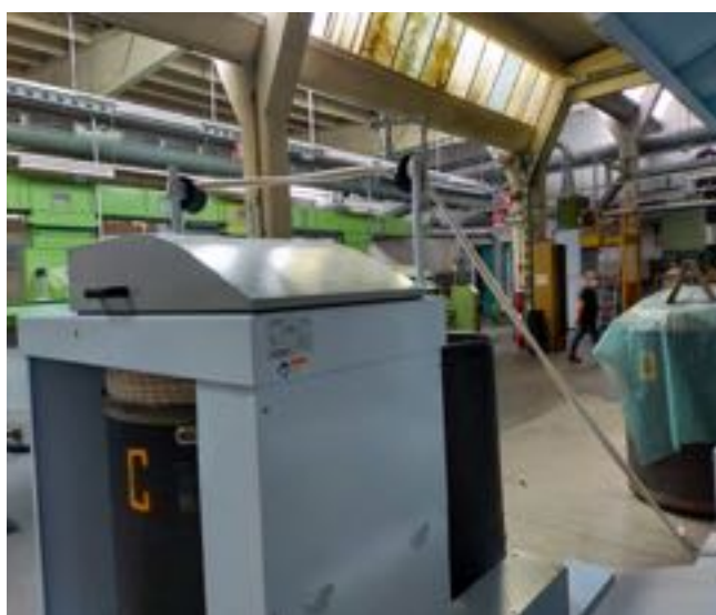
Figura 55 – Fase 5: Passaggio di cardatura, in cui le fibre vengono trasformate in un nastro di carda che viene depositato all'interno di grossi recipienti cilindrici, chiamati vasi.
