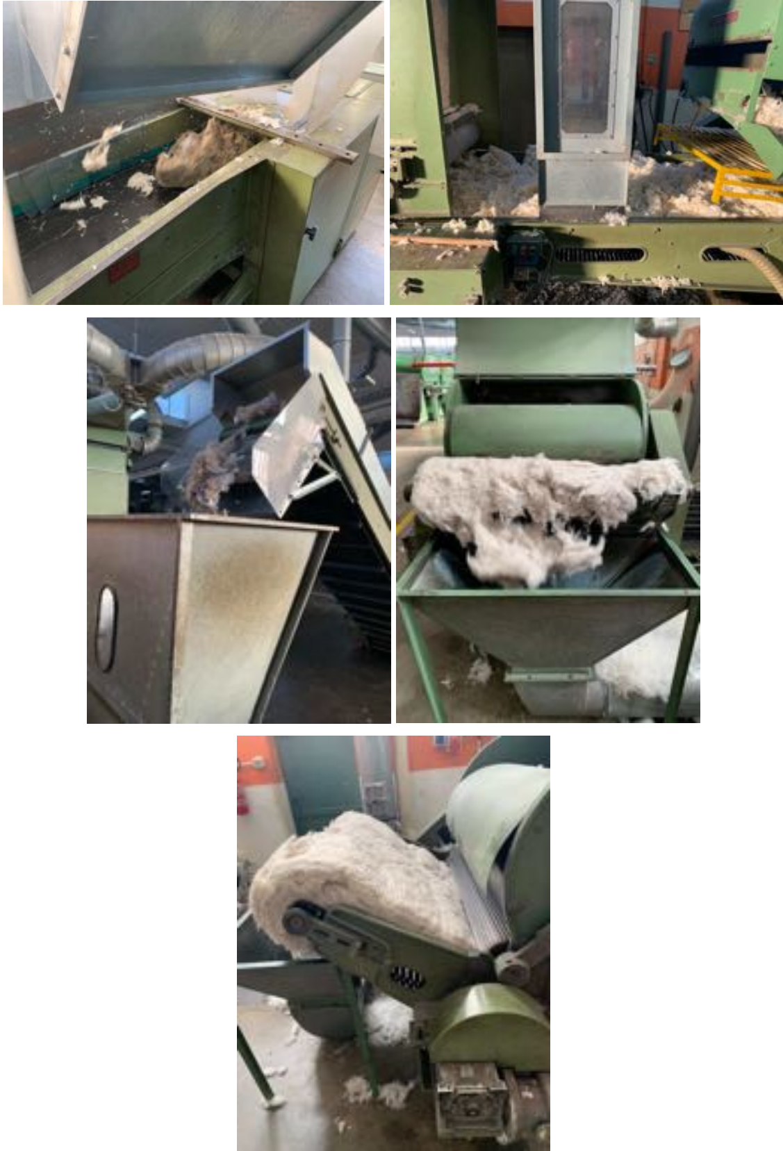
Figura 53 – Fase 3: Lavorazione di sfilacciatura, che consiste nell'aprire le false cimosse e poi i filati per riportarli allo stato di fibra. Tale lavorazione avviene attraverso dei pettini molto appuntiti che sfibrano il materiale, il quale viene spinto su un tappeto con forte corrente d'aria.
