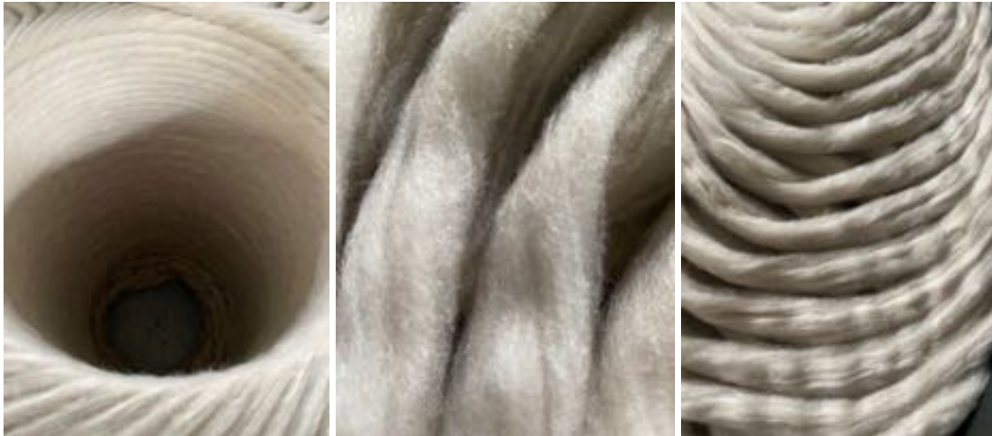
Figura 56 – Nastro di fibre coese, disposto in modo circolare all'interno del vaso; le fibre possono presentare più o meno sfumature a seconda dei diversi colori che si sono miscelati tra di loro.
