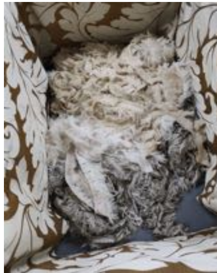
Figura 51 – Fase 1: Raccolta avanzi in base ai criteri stabiliti (fibre naturali, per lo più discontinue, colori medio chiari).
