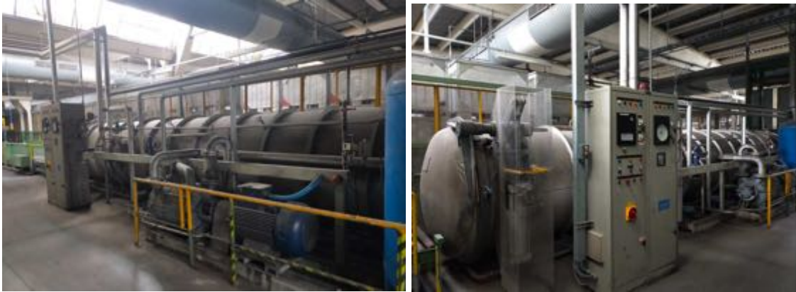
Figura 59 – Fase 8: Vaporizzo in autoclave per dare una mano molto più morbida e meno nervosa al filato.
