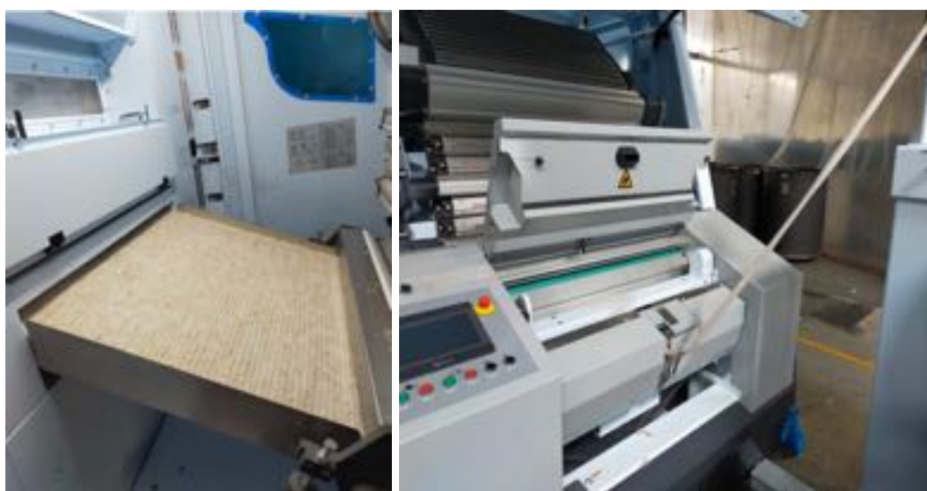
Figura 54 – Fase 4: Miscelazione del materiale sfilacciato con 25% di fibra poliestere riciclato certificato GRS.
