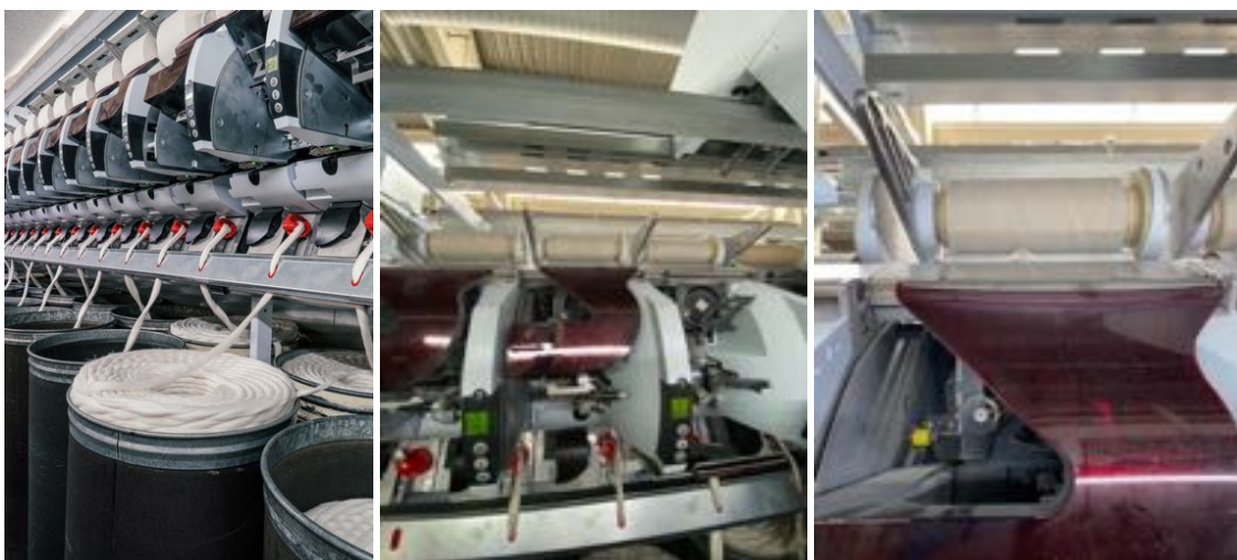
Figura 58 – Fase 7: Processo di filatura open-end, che lascia le fibre coese, ma gonfie e senza troppi giri di torsione.
