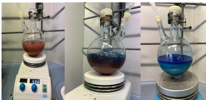
Figura 17 – Foto dell' avanzamento dell' ossidazione del rame
