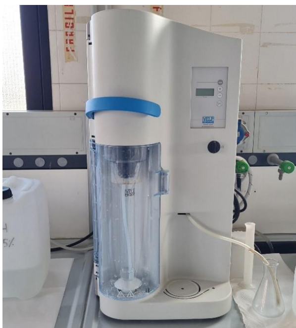
Figura 7 Distillatore Velp Scientifica UDK 129 impiegato per le analisi.
