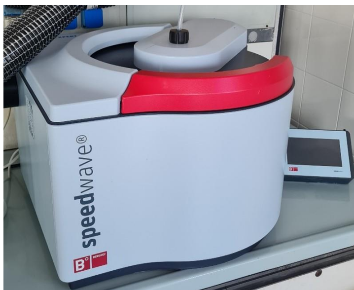
Figura 8 Mineralizzatore Speedwave XPert impiegato per la digestione dei campioni.
