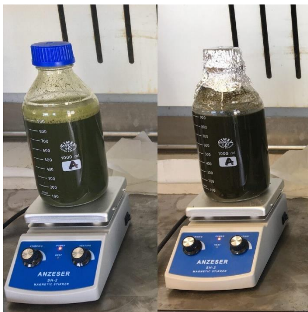
Figura 11 Confronto tra un campione prima dell'aggiunta dell'idrossido di sodio (sinistra) e il black liquor ottenuto post-trattamento (destra).
