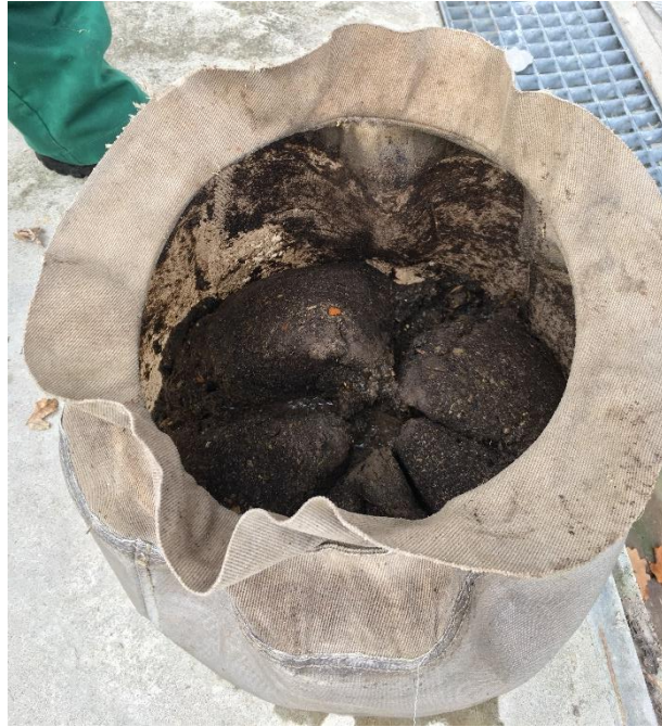
Figura 3 Fase solida estratta dal processo di centrifugazione).
