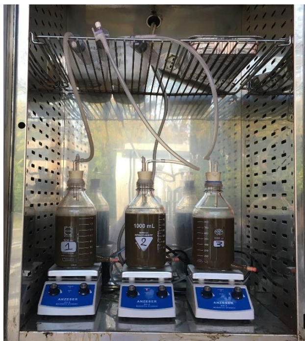
Figura 9 Disposizione delle tre Run su agitatore magnetico all'interno della stufa.
