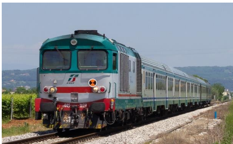
Figura 15 – Tipico materiale ordinario a trazione diesel circolante nelle linee della Regione Veneto fino a dicembre 2020: locomotore D.445 con 5 vetture Media Distanza a seguito.
