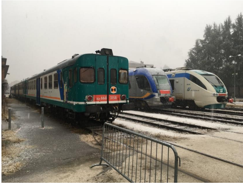
Figura 16 - Le tre tipologie di mezzi leggeri a trazione diesel circolanti nelle linee della Regione Veneto: (da sinistra) una terna di ALn668 (circolante fino a giugno 2021), ATR220 ( Swing ) ed ALn501/502 ( Minuetto ).
