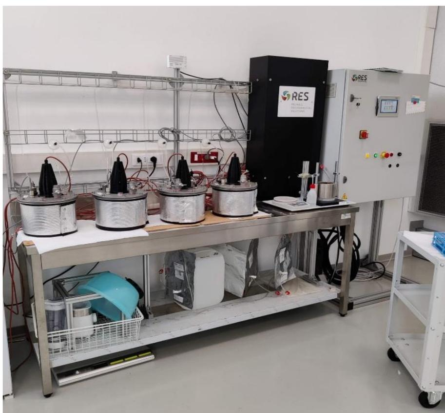
Figura 10, Fermentatori batch utilizzati nei test di Dark Fermentation (RES Italia)
