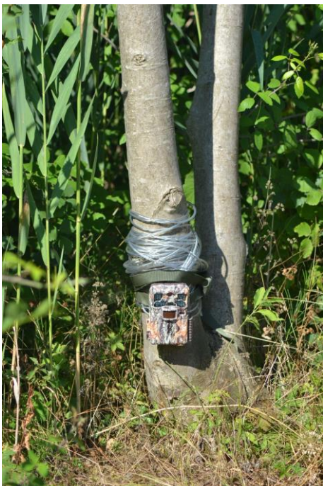
Figura 9 Fototrappola nella posizione M1 legata con cinturino e assicurata con filo d'acciaio
