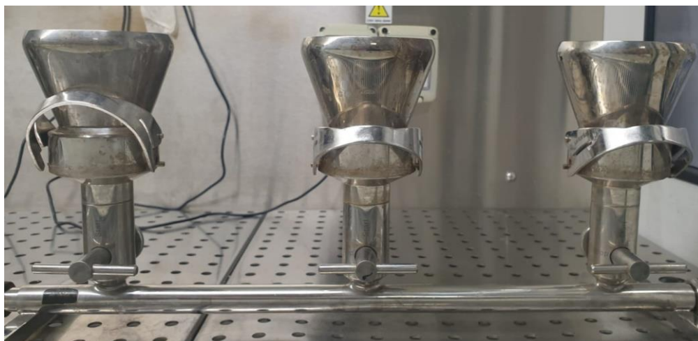
Figura 6 Rampa di filtrazione.
