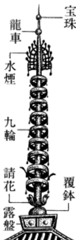
FIGURA 19. Schema della composizione tipica di un sōrin , Seisenban nihon kokugo daijiten 精選版 日本国語大辞典,
