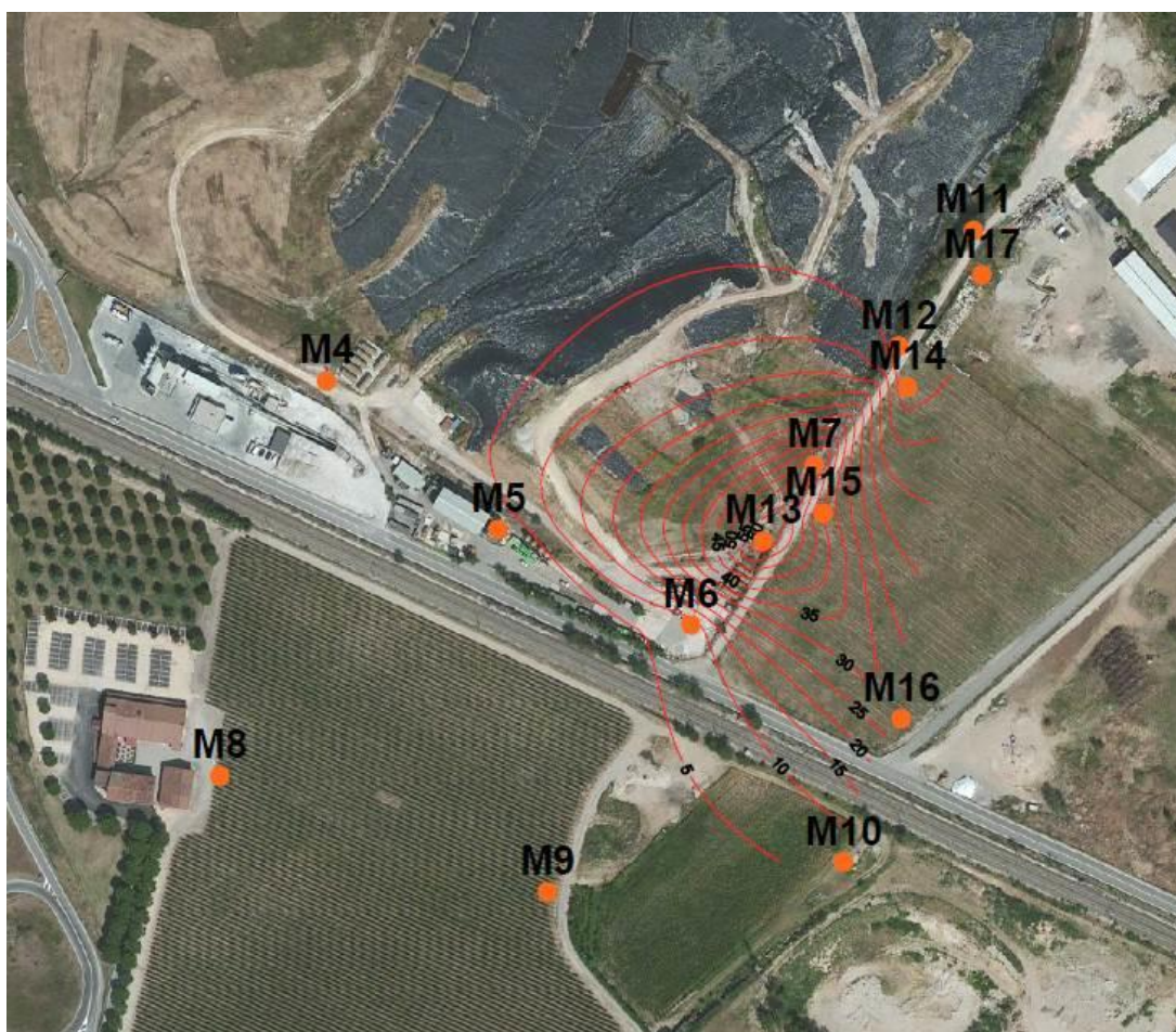
Figura 16: Distribuzione spaziale della contaminazione di azoto ammoniacale nel 2014. (Fonte: Progetto operativo di messa in sicurezza Acque di falda. I.S.E.R. S.r.l.)
