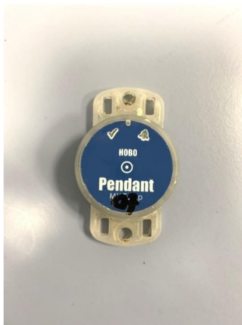
Figura 27. Una delle sonde di temperatura che sono state posizionate nelle 11 stazioni di Valle Averno con il fine di monitorare costantemente le variazioni della temperatura delle acque.
