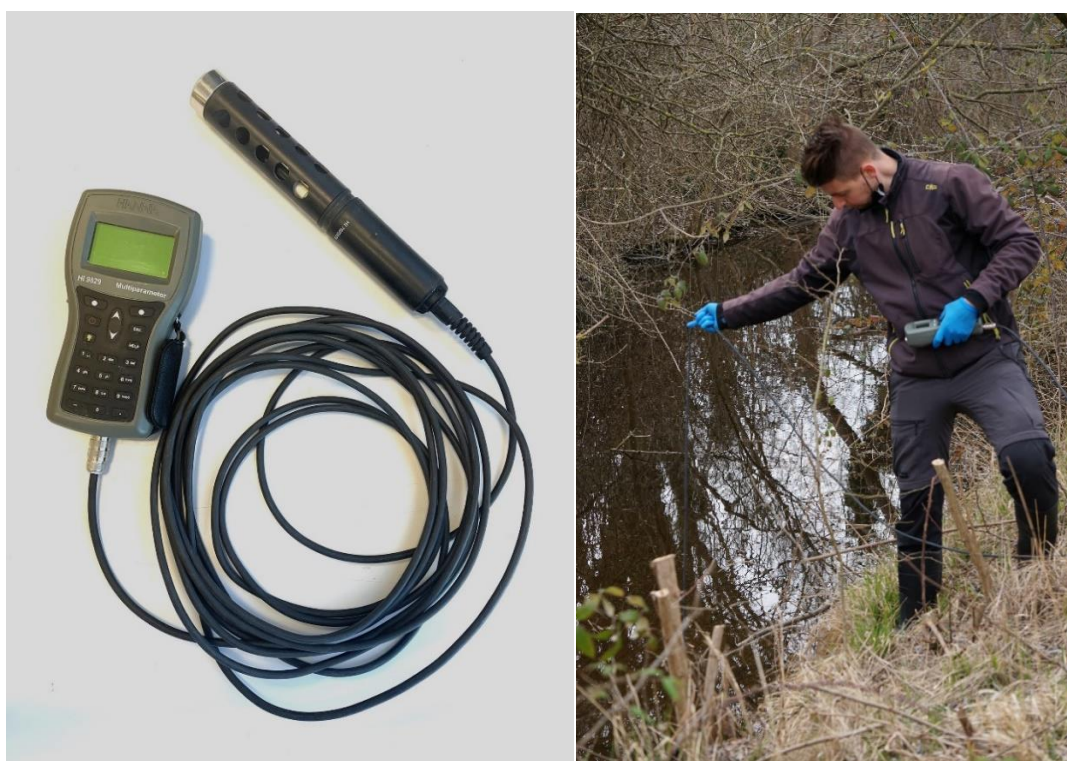
Figura 26. Sonda multi-parametrica utilizzata per effettuare i rilevamenti (sinistra); fase di rilevamento in campo dei parametri chimico-fisici delle acque di Valle Averte (destra).
