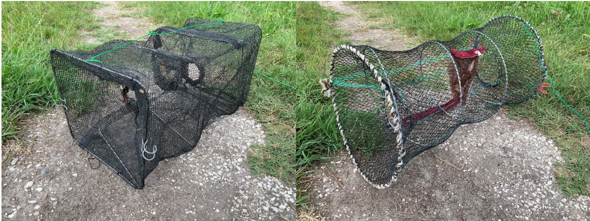
Figura 33. Nasse utilizzate per il campionamento della fauna acquatica in Valle Averno: nassa a maglia più fina (sinistra) e nassa a maglia più grossa (destra).
