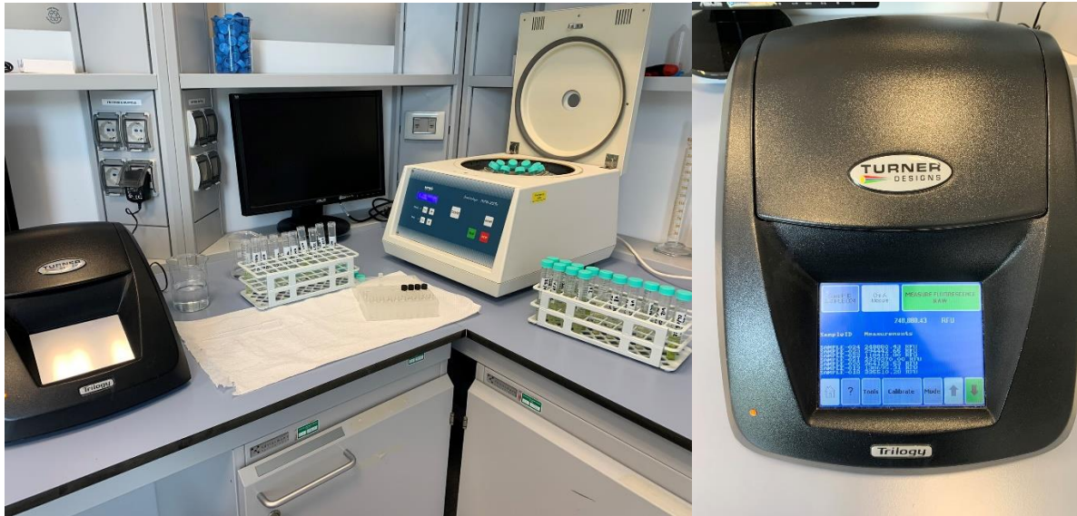
Figura 29. Postazione del laboratorio con fluorimetro, e centrifuga, strumenti necessari per l'analisi della clorofilla (sinistra); fluorimetro utilizzato (destra).
