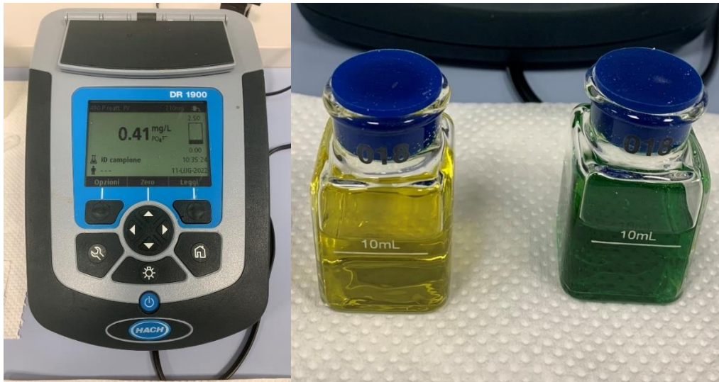
Figura 30. Spettrofotometro utilizzato per le analisi dei nutrienti in laboratorio (sinistra); cuvette contenenti campioni d'acqua e reagenti per l'analisi dell'ammoniaca (destra).
