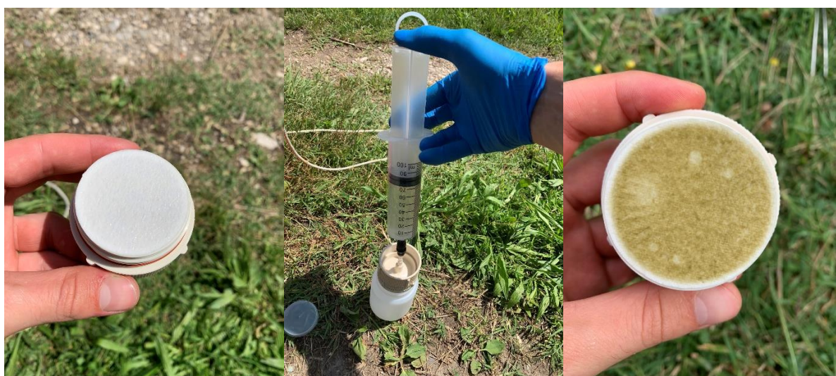
Figura 28. Filtro pulito posizionato sul portafiltro (sinistra); fase di filtraggio dell'acqua (centro); filtro post filtraggio da portare in laboratorio per effettuare l'analisi della clorofilla (destra).
