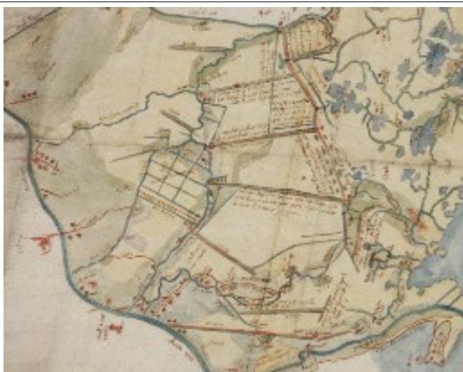
Le numerose strade-argini segnate in una copia di mappa del XVI secolo poste tra Codevigo e Lova sul margine odierno lagunare. Si può osservare che sono affiancate da canali di scolo. ASV, Misc. Mappe, dis. 25, 28 novembre 1665 copia da originale del XVI secolo.
