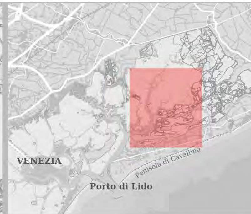
TAVOLA 10 Posizionamento degli argini con gabbia lignea con diagramma di Voronoi scala 1:40000
