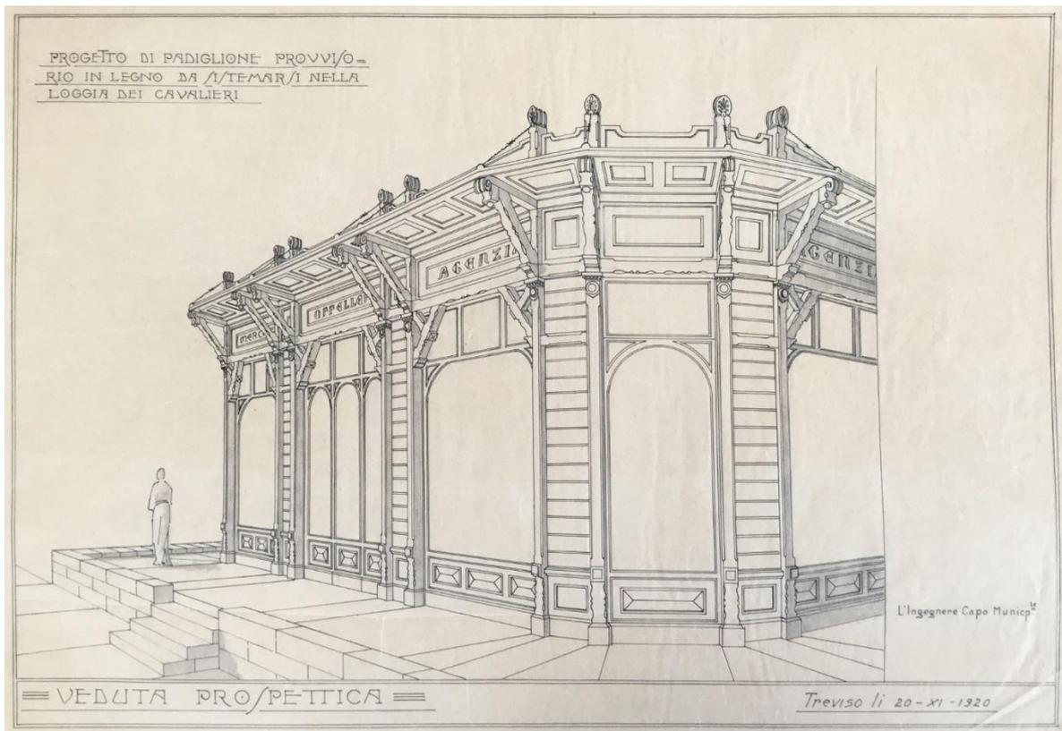
Fig. 22. Progetto di padiglione provvisorio in legno per coprire la Loggia (R. Milani, 20.11.1920).
