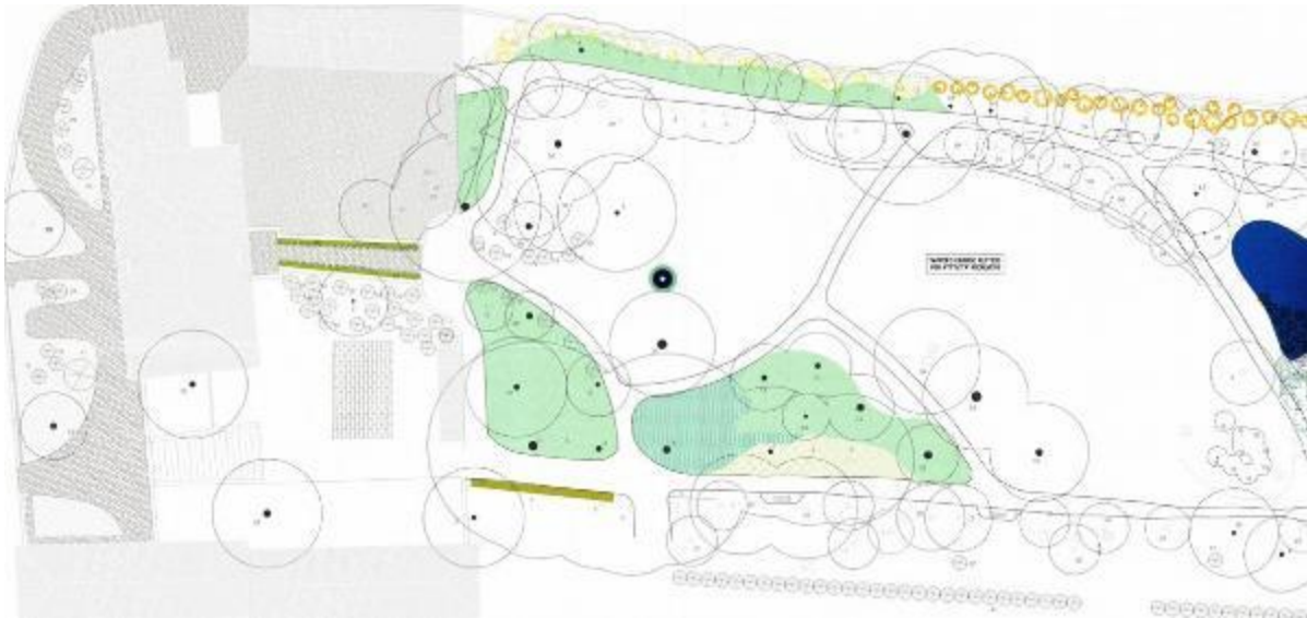
Fig. 8 Stato di progetto, planimetria, superfici prative ed arbustive a dimora, 2003 (Comune di San Giovanni al Natisone, restauro del parco nel complesso di Villa de Brandis, Tav. n. 4)
