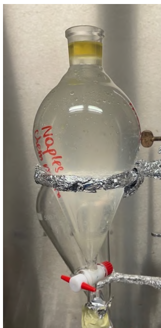
Figura 2.7 Oleostrazione di SMPs, APFs e altre componenti del microlitter, con decantazione delle fibre appartenenti al filtro GF/F per il campione di Napoli.
