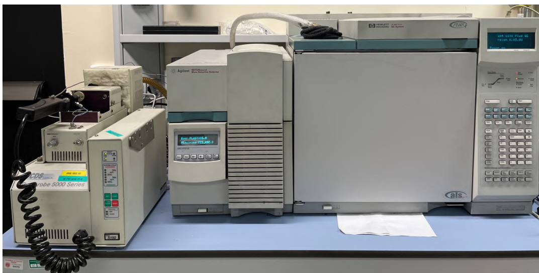
Figura 2.14 PYR-GC/MS, composto da pirolizzatore Pyroprobe® 5000 Series, CDS Analytical Inc., gascromatografo HP Agilent 6890 Plus Gas Chromatograph, spettrometro di massa Agilent 5973 Network Mass Selective Detector.
