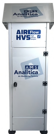
Figura 2.1 Campionatore ad alto volume AirFlow PUF (AMS Analitica Strumenti).
