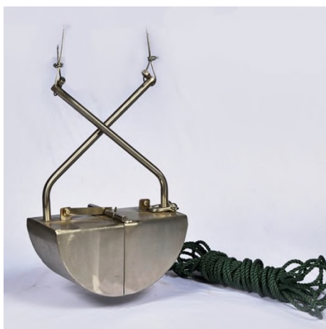
Figura 1.16 Rappresentazione della benna di Van Veen .
