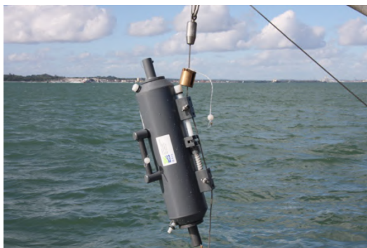
Figura 1.15 Rappresentazione della bottiglia di Niskin.
