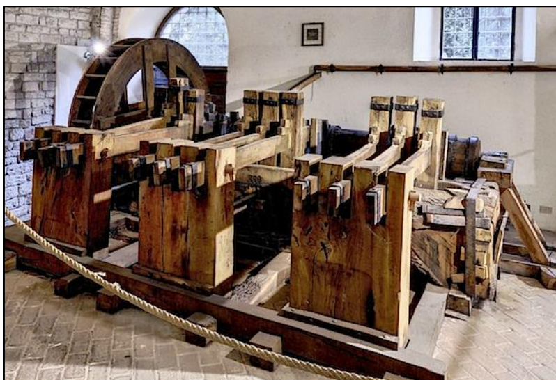
Figura 22. Pila idraulica a magli multipli conservata nel Museo della Carta e della Filigrana di Fabriano.
