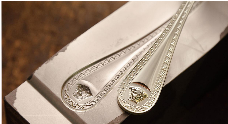
Figura 16 - Particolare di decoro ottenuto tramite punzonatura e relativo punzone, (Sambonet) 99
