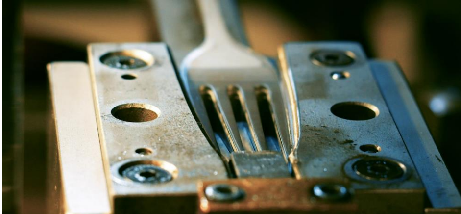
Figura 14 - Particolare di forchetta Sambonet nello stampo, (Industria Italiana) 95
