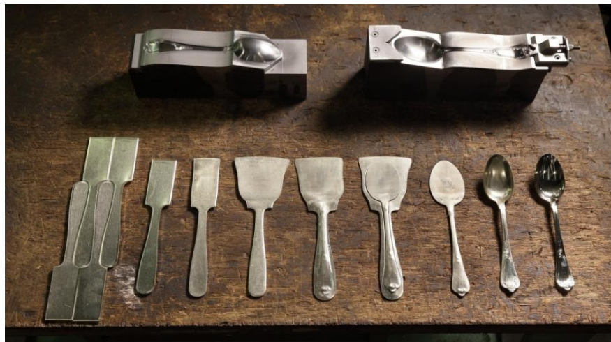
Figura 19 - Tutti gli stadi di produzione del cucchiaio Sambonet con il metodo dello stampaggio, (Industria Italiana) 108
