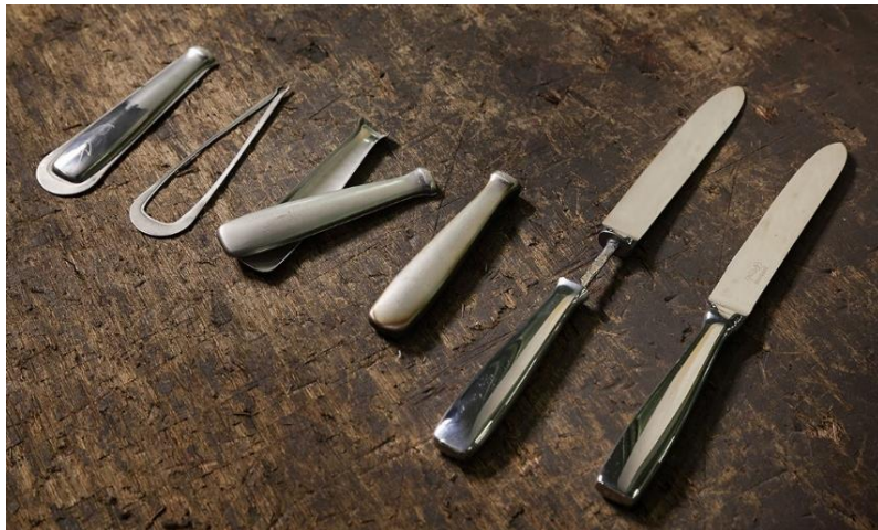
Figura 20 - Tutti gli stadi di produzione di un coltello a manico cavo, (Sambonet) 129
