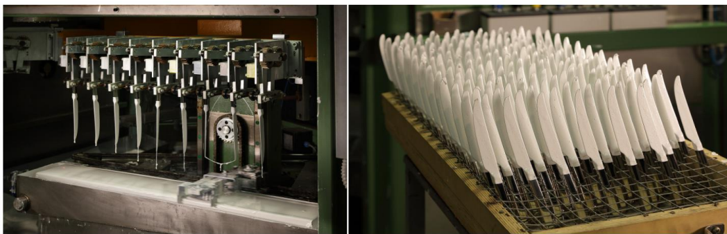
Figura 32 - Preparazione delle lame dei coltelli con la vernice isolante, (Sambonet) 180
