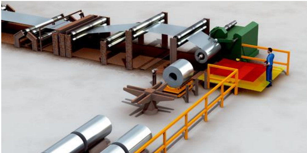
Figura 21 - Aspo svolgitor e avvolgitor, (SICK) 131
