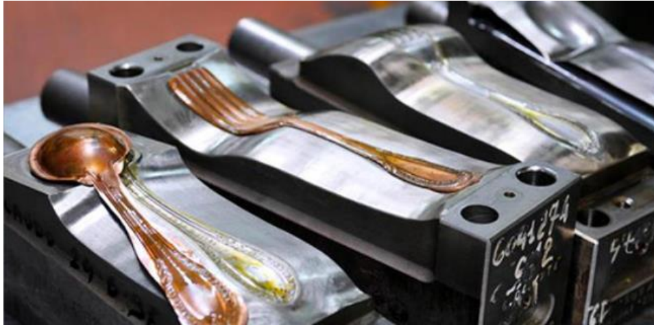
Figura 18 - Stampi per coniatura, (Greggio) 103
