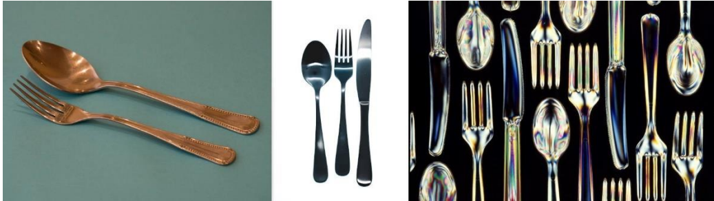
Figura 34 - Esempi di rivestimenti in PVD: dorato, argentato, colorato (da sx a dx), (CM Group) 194
