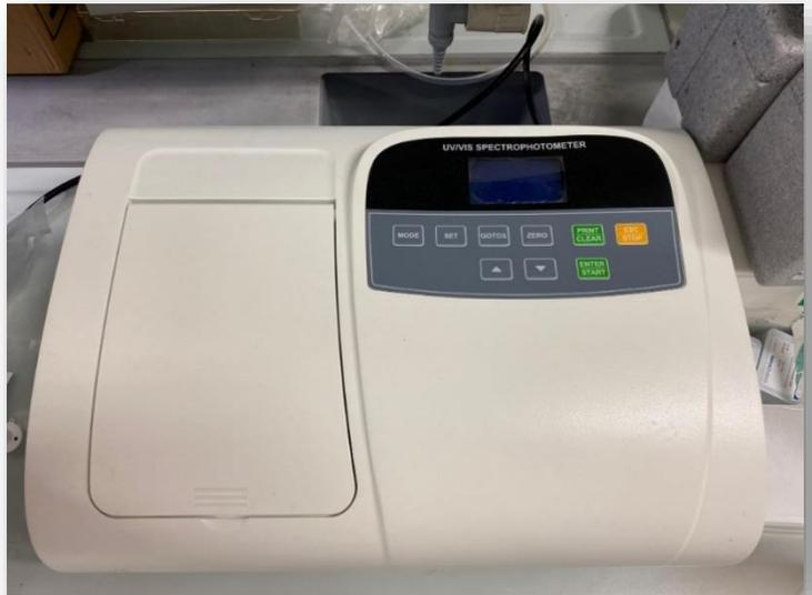
Figura 46 - spettrofotometro UV/VIS
