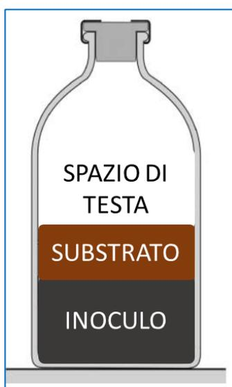
Figura 13 - Schema di un vessel per test di biometanazione (modificato da Angelidaki et al., 2009)
