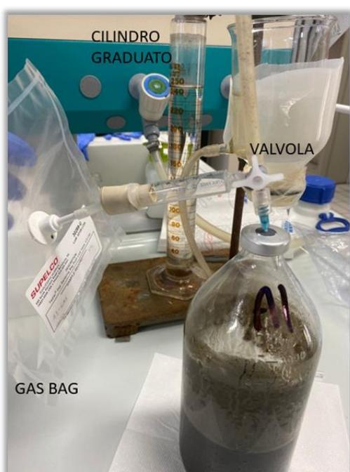
Figura 14- raccolta del biogas e sua misurazione volumetrica
