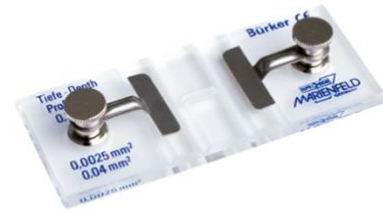
Figura 21: camera di conta di Bürker. Sono visibili le pinze che fermano il vetrino, al di sotto del quale sono presenti i due loci dove va inoculata la soluzione contenente le cellule da contare. Si può vedere anche l'indicazione del volume. Da https://magapor.com/en/portfolio-items/burker/ (modificato).
