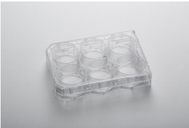
Figura 23: piastra sterile in polistirene da 6 pozzetti utilizzata per il test con il cladocero Daphnia magna (Straus, 1820). Da https://www.starlabgroup.com/IT-it/product/piastra-a-6-pozzetti-cytoone-trattata-cc7682-7506.html (modificato).
