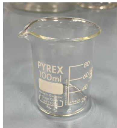
Figura 29: becher in vetro Pyrex da 100 mL, utilizzato per il test cronico con D. magna . In ciascuno vengono posti 50 mL di soluzione, con all'interno anche il tossico e un individuo giovane.
