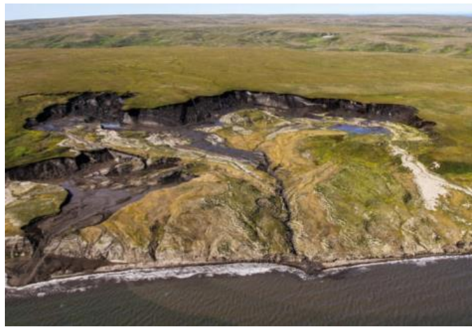
Figura 8: esempio di frana costiera regressiva da fusione a Herschel Island, mare di Beaufort, Canada (Obu, 2015)
