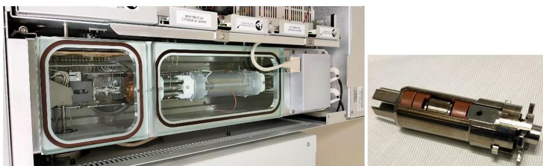
Figura 41: a sinistra foto analizzatore triplo quadrupolo. A destra sorgente a impatto elettronico
