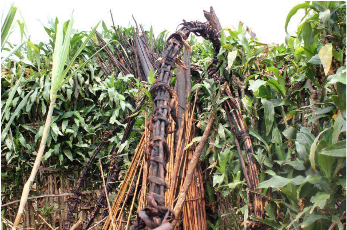
Figura 26. Materiali vegetali per la costruzione di una casa a Lurhala, tra cui le circonferenze di canne intrecciate ( chizizi )
