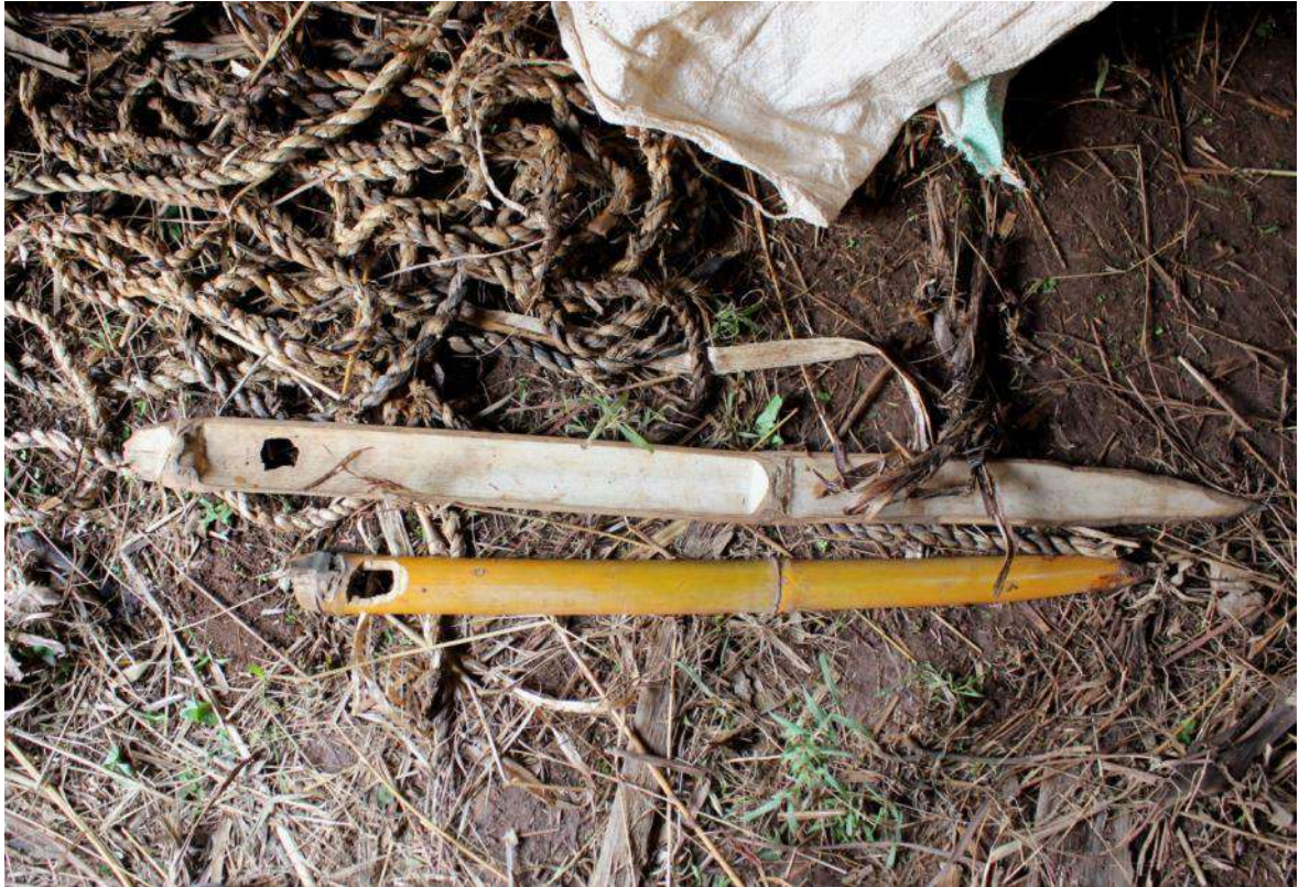
Figura 35. Ago in bambù e corda in fibra di banana utilizzati per il fissaggio della paglia di copertura, Mudaka
