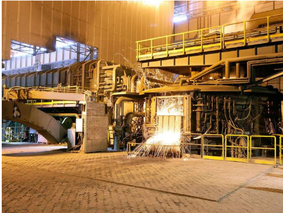
Figura 7: Il forno elettrico di Arvedi a Cremona
