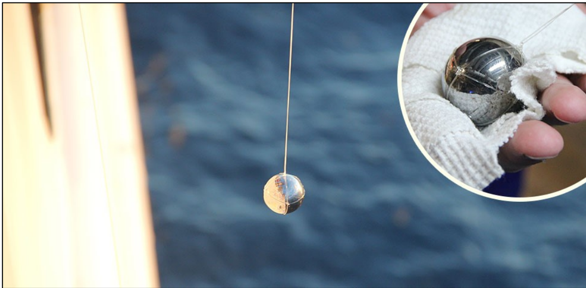
Figura 7. Sfera di calibrazione in carburo di tungsteno utilizzata per tarare l'echosounder scientifico.
