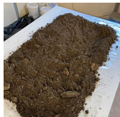
FIGURA 16: DISTENSIONE DEL CAMPIONE DI TERRENO PER FAVORIRNE L'ESSICAMENTO.
