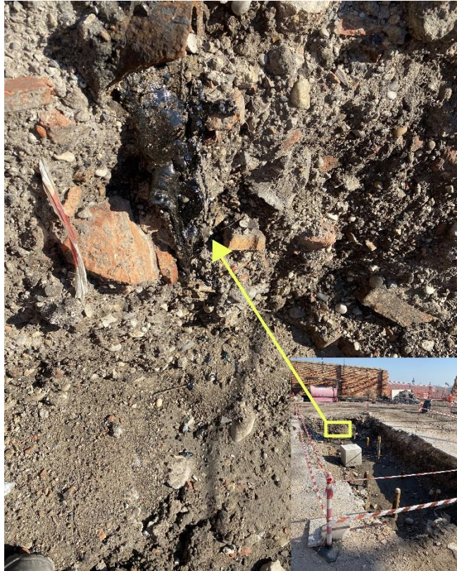
FIGURA 15: PARTICOLARE DI UN RESIDUO CATRAMOSO ALL'INTERNO DELL'AREA HOT-SPOT. SONO STATI RACCOLTI CIRCA 6 KG DI QUESTO MATERIALE.
