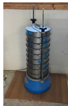
FIGURA 17: SETACCI IMPILATI SUL VIBROVAGLIO. LE VIBRAZIONI DELLO STRUMENTO PERMETTONO DI VAGLIARE IL CAMPIONE.
