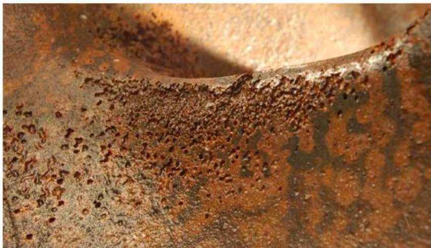
Figura 14. Erosione dovuta alla cavitazione in una girante monocanale di un impianto di trattamento delle acque reflue (Thamsen et al., 2008).
