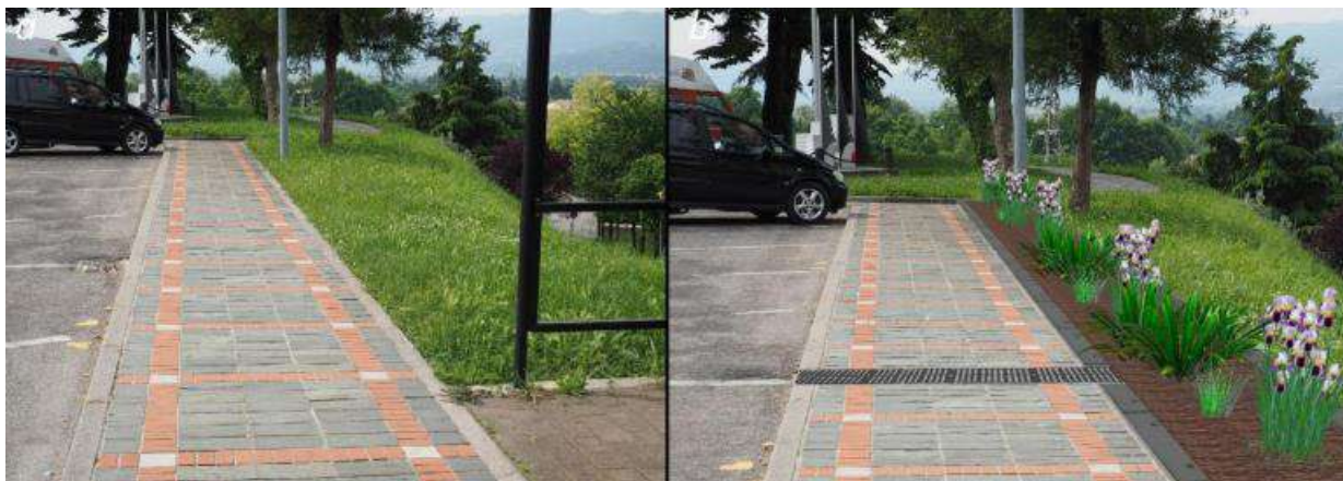
Figura 45: Porzione del Piazzale della Libertà ora (a) e previsione di come sarà dopo la realizzazione della bioritenzione sottodrenata, intervento 1
