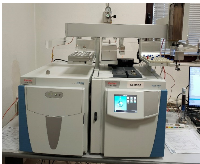
Figura 4.3.1 - Gascromatografo Trace 1310 con TSQ9000 e Autocampionatore PAL Thermo Fisher Scientific utilizzato in questo lavoro
