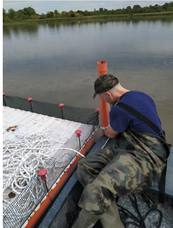
Figura 5.5. Congiunzione di un angolo di una zattera ad una palina. (Foto: S.M. Preo).
