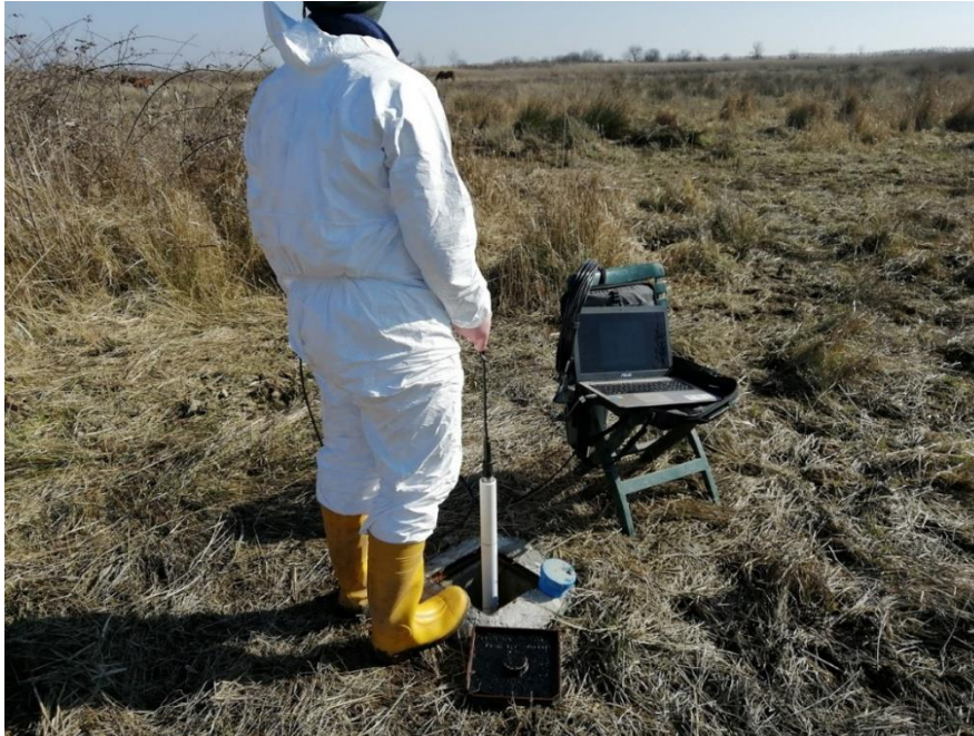
Fig. 3.7. Misurazione dei parametri delle acque sotterranee in uno dei piezometri dell'Oasi WWF di Valle Averno attraverso l'impiego di una sonda multiparametrica (Fonte: LIFE ForestAll)
