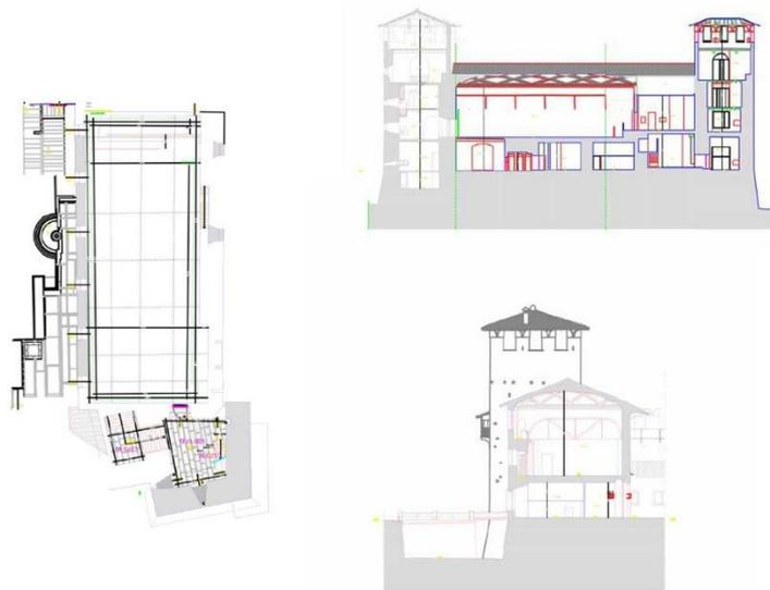
Figura 4.13: Planimetria e sezioni trasversale e longitudinale di Sala Boggian, Castelvecchio
