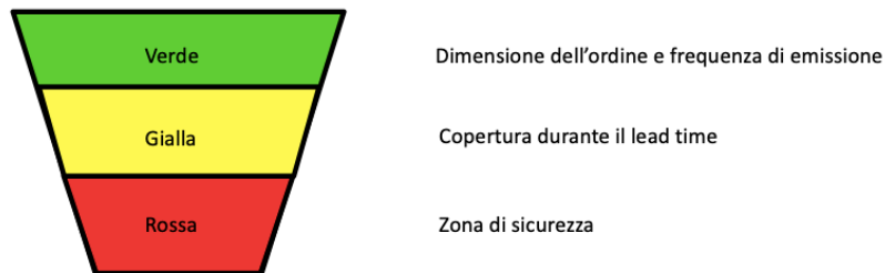
Figura 3-12. Struttura di un buffer
