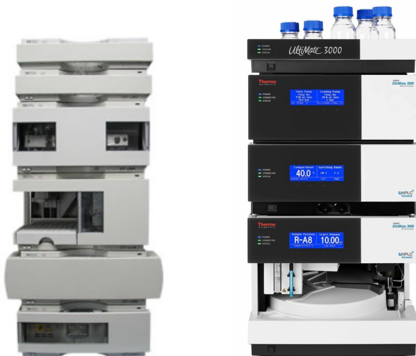
Figura 1.7: A sinistra immagine di un HPLC Agilent Serie 1100 e a destra immagine di un UHPLC UltiMate 3000.
