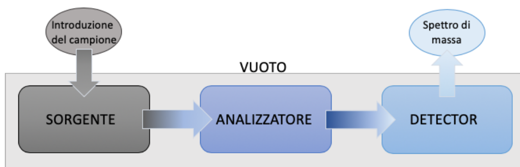
Figura 1.8: Schema generale di uno spettrometro di massa.
