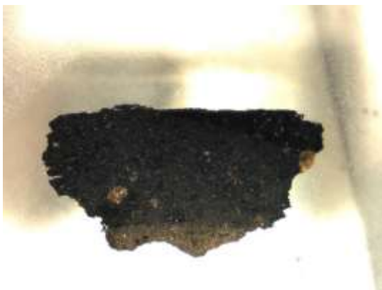
Fig. 34 - Foto allo stereomicroscopio del campione n.16 inglobato in resina, esemplificativo del gruppo C. Lato lungo della foto 14,4 mm
