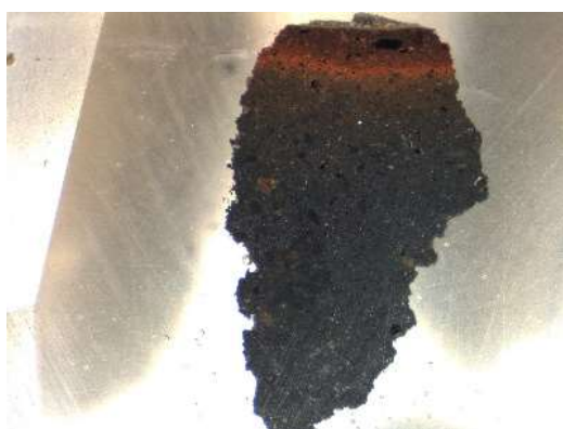
Fig. 31 – Foto allo stereomicroscopio del campione n.5 inglobato in resina, esemplificativo del gruppo A. Lato lungo della foto 14,4 mm.
