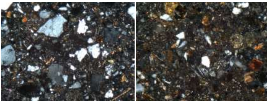
Fig. 1 - Foto al microscopio polarizzatore della sezione sottile del campione n.25, il mattone crudo. Lato lungo: a) 1,95 mm; b) 0,96 mm.
