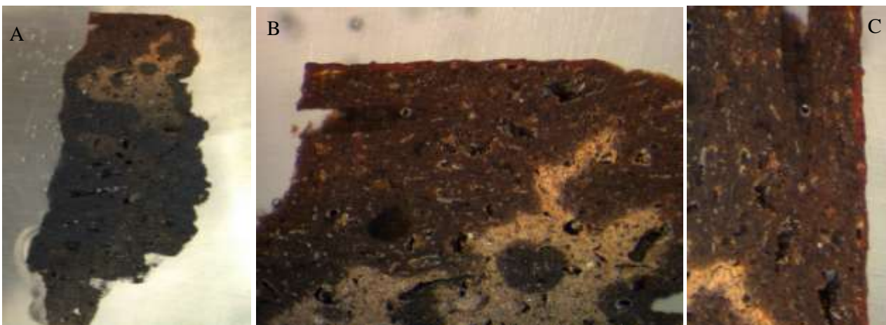
Fig. 4 - Foto allo stereomicroscopio del campione n.10 inglobato in resina. Lato lungo: a) 14,4 mm; b) 3,8 mm; c) 2,5 mm.
