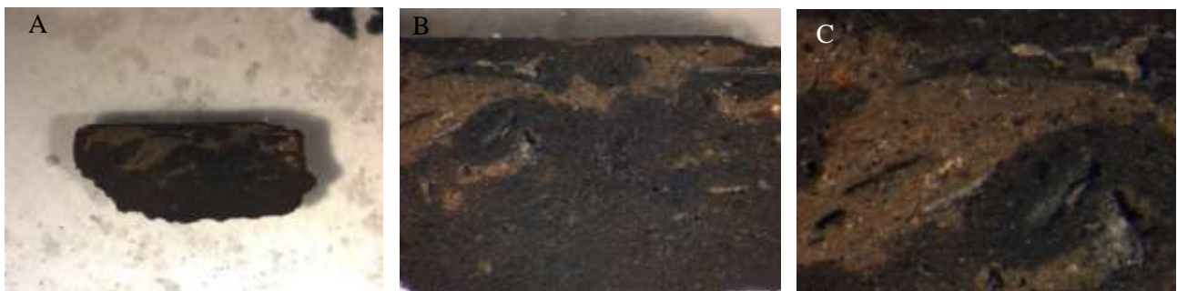
Fig. 4 - Foto allo stereomicroscopio del campione n.17 inglobato in resina. Lato lungo: a) 14,4 mm; b) 5,8 mm; c) 2,5 mm.
