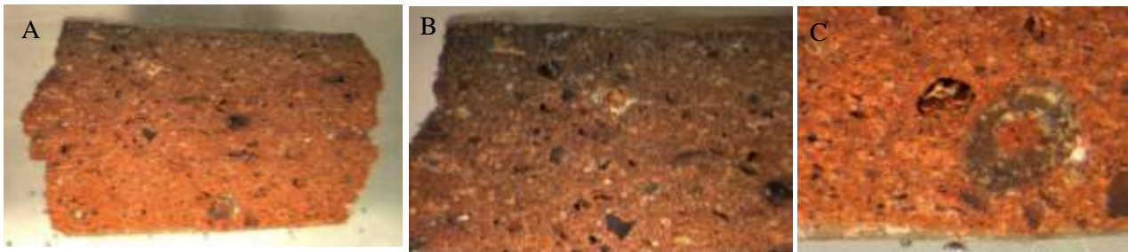
Fig. 4 - Foto allo stereomicroscopio del campione n.13 inglobato in resina. Lato lungo: a) 14,4 mm; b-c) 2,5 mm.
