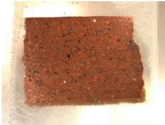
Fig. 33 - Foto allo stereomicroscopio del campione n.19 inglobato in resina, esemplificativo del gruppo B. Lato lungo della foto 14,4 mm.
