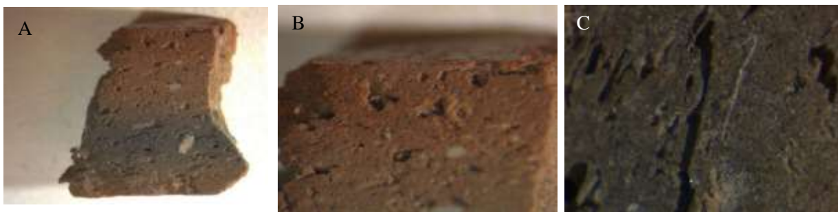
Fig. 3 - Foto allo stereomicroscopio del campione n.7 abraso. Lato lungo: a) 14,4 mm; b) 5,8 mm; c) 2,5 mm.
