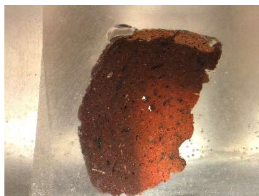
Fig. 32 – Foto allo stereomicroscopio del campione n.15 inglobato in resina, esemplificativo del sottogruppo con patina superficiale. Lato lungo della foto 14,4 mm.
