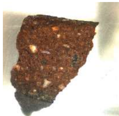
Fig. 35 - Foto allo stereomicroscopio del campione n.18 inglobato in resina, esemplificativo del gruppo D. Lato lungo della foto 14,4 mm.
