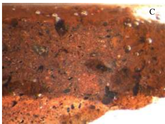
Fig. 3 - Foto allo stereomicroscopio del campione n.14 inglobato in resina, diviso tra area rossa e nera. Lato lungo: a-b) 14,4 mm; c-d) 3,8 mm.
