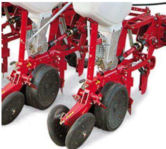
Figura 16 – Seminatrice con trasmissione del moto di tipo meccanico al sistema di distribuzione, (Nicolas NAUVA) 65
