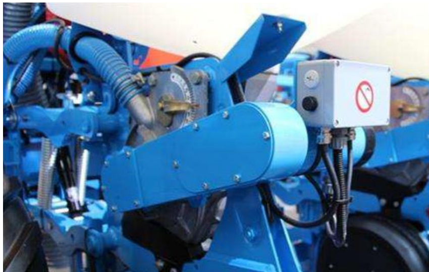
Figura 17 – Motore elettrico di potenza limitata per l'azionamento del sistema di distribuzione, (Nicolas NAUVA) 67
