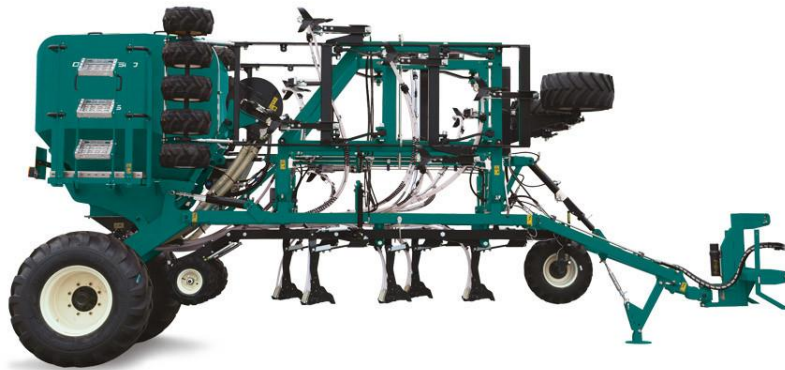
Figura 29 – Seminatrice pneumatica ad utilizzo su terreni a minima lavorazione o non lavorati, (MaterMacc S.p.A.) 125
