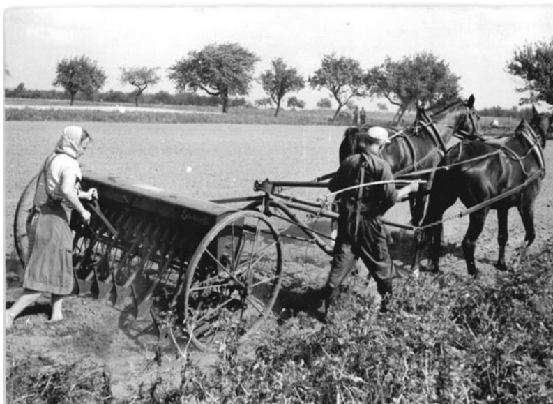
Figura 3 – Modello di seminatrice in ferro diffusa negli anni cinquanta. Foto risalente al 1954, (Le seminatrici nell'agricoltura italiana degli anni '50 – '60) 17
