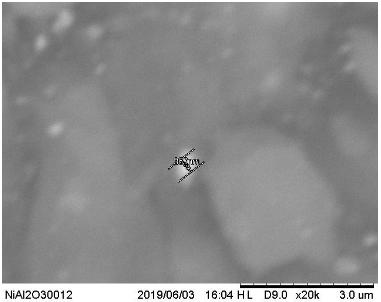
Figura 3.3.14 Centro di Ni su Ni/Al 2 O 3 . Ingrandimento x20000
