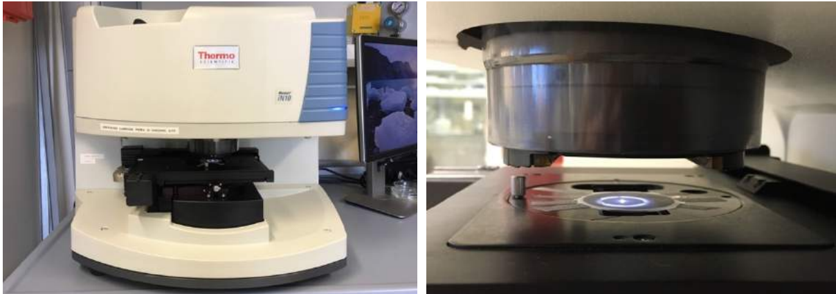
Fig. 2.4.3. \mu FTIR (Micro-Fourier transform infrared spectrometry) presso il CNR-ISP di Venezia col quale sono state eseguite le analisi.
