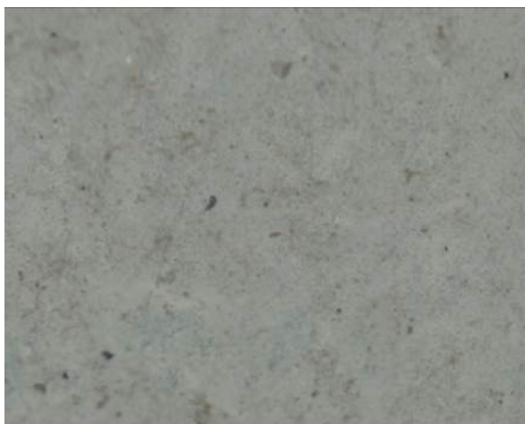
Fig. 3.2.1. immagine catturata col microscopio dello strumento del filtro non purificato e ricoperto di particolato, impossibile da analizzare.
