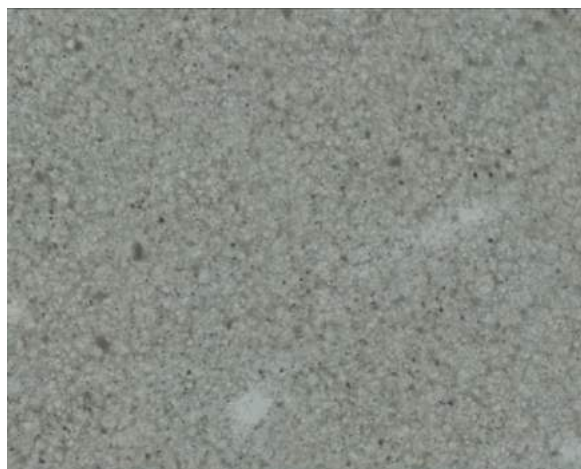
Fig. 3.1.4. immagine catturata col microscopio dello strumento dove si può notare il particolato presente sul filtro.
