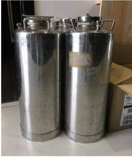
Fig. 2.2.1. Nella prima foto sono rappresentate delle bottiglie in acciaio utilizzate per il campionamento dell'acqua superficiale, nella seconda foto è rappresentata la Benna utilizzata per il campionamento dei sedimenti.
