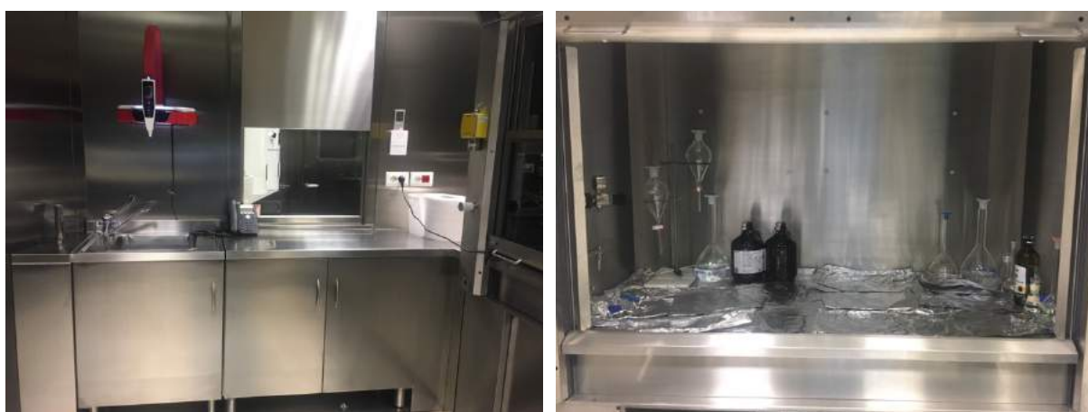
Fig. 2.3.1. Foto raffiguranti la Clean Room (ISO 7) in cui sono stati trattati i campioni di acqua e sedimento, laboratorio completamente privo di materiali plastici.
