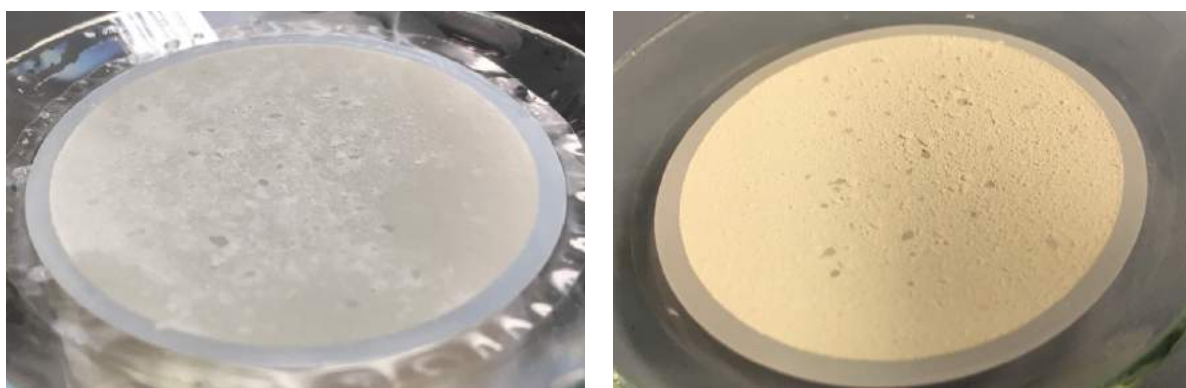
Fig. 3.1.1. Campione trattato con soluzione di zinco cloruro. Foto prima e dopo essiccazione del filtro
