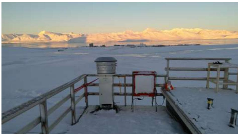
Figura 3.3 Impattore posto sul tetto del laboratorio di Gruvebadet e, sullo sfondo, il villaggio di Ny Ålesund
