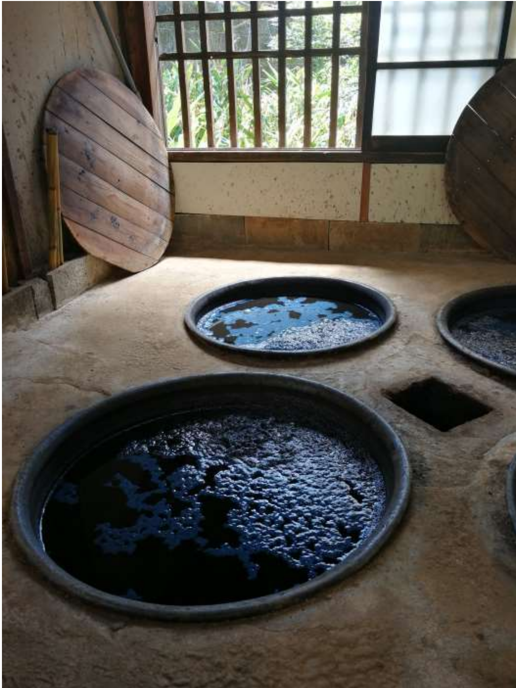
Immagine 43. La superficie del liquido per la tintura presenta della schiuma, altro indicatore della qualità del composto. Ogni quattro pozzi è presente una piccola apertura (a destra nell'immagine) dove viene inserito il carbone per accendere il fuoco che serve a mantenere la temperatura costante. Bottega Aizome kasuri del maestro Yamamura. Materiale dell'autore.
