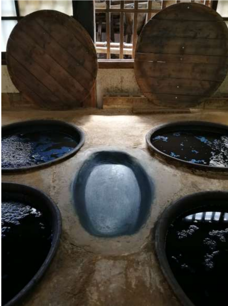
Immagine 44. Al centro, la concavità dove viene sbattuta la matassa dopo l'immersione nella tinta. Bottega Aizome kasuri del maestro Yamamura. Materiale dell'autore.
