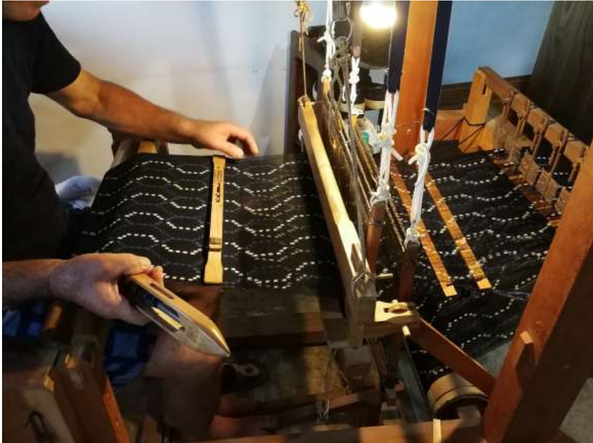
Immagine 48. Fase della tessitura su telaio a mano secondo il metodo artigianale. Il tessitore tiene nella mano sinistra la spoletta. Nella foto, il maestro Yamamura nella sua bottega. Materiale dell'autore.
