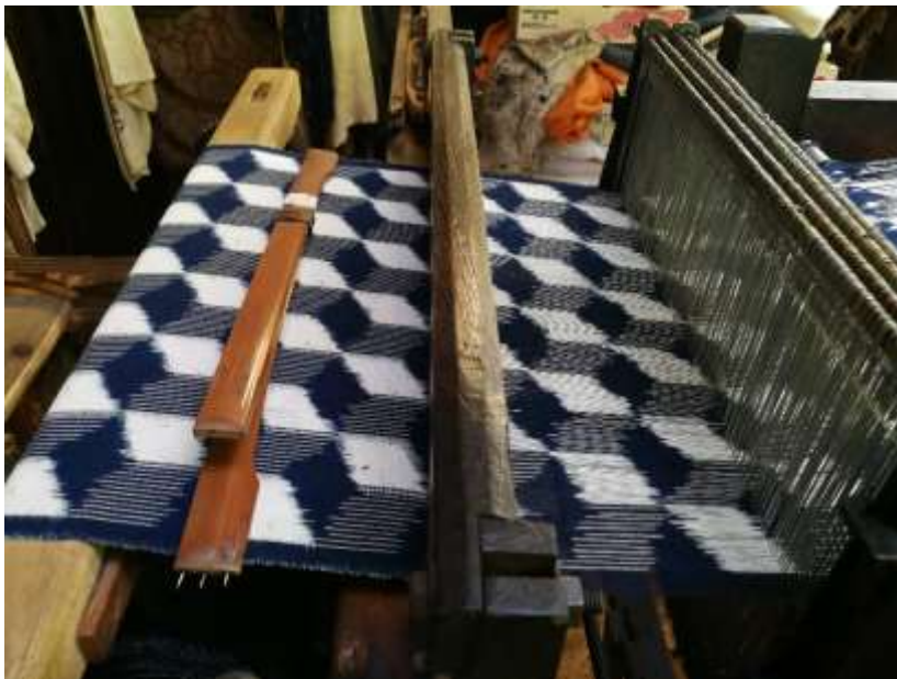
Immagine 51. Dettaglio del telaio meccanico (immagine). Si notano i licci, a destra, e l'estremità del tessuto finito a sinistra. Il motivo di questo kasuri è geometrico con effetto tridimensionale, ideato dal maestro Yamamura. Materiale dell'autore.
