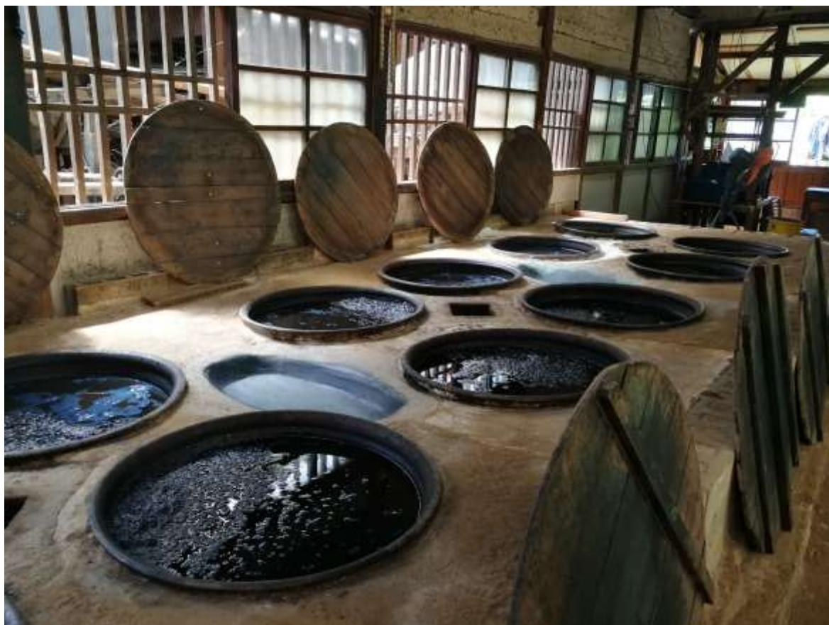
Immagine 42. I pozzi contenenti la tradizionale tintura blu. In un atelier ci sono dagli otto ai dodici pozzi (in questa foto ve ne sono dieci). Ogni pozzo è dotato di coperchio in legno. Bottega Aizome kasuri del maestro Yamamura. Materiale dell'autore.
